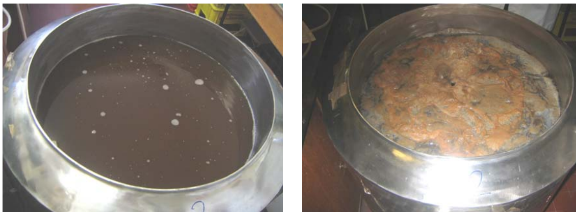
Slika 39. Reaktor za kombuha fermentaciju ukupne zapremine 110 L
