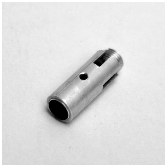
Slika 10.11 Izgled kućišta mikrofona sa ugrađenim mikrofonom
