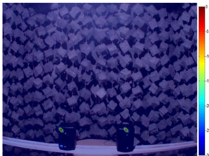
Slika 2.18 Rezultat lokalizacije pomoću algoritma CLEAN-SC
