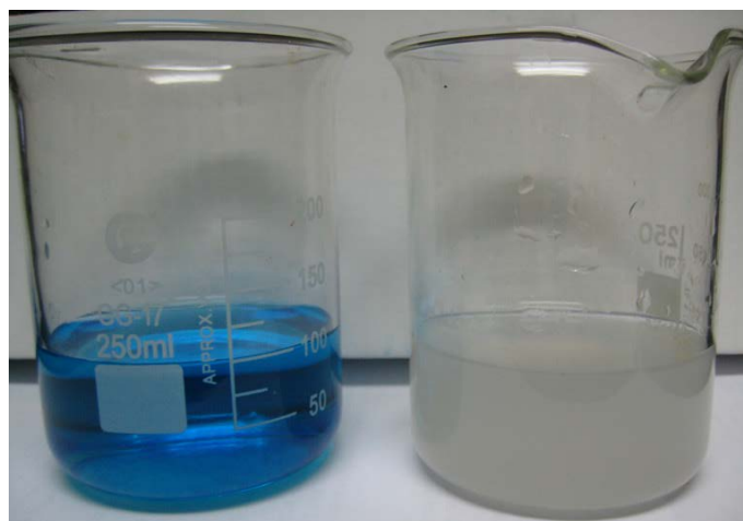
Slika 107 Poređenje boje rastvora metilenskog plavog nakon 3 h UV zračenja, čaša sa rastvorom metilenskog plavog bez uzorka (levo) i čaša sa obezbojenim rastvorom metilenskog plavog sa uzorkom K_ZnAl_3Ti_B (desno)
