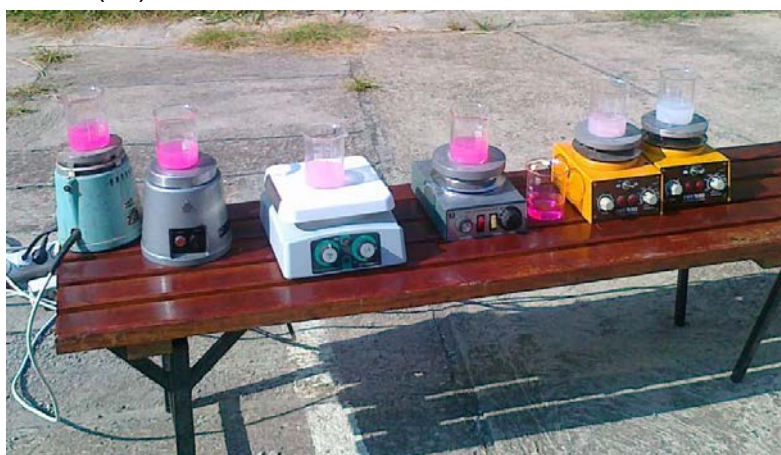
Slika 43 Ispitivanje efikasnosti pri sunčevim zračenjem upotrebom RB kao model polutanta
