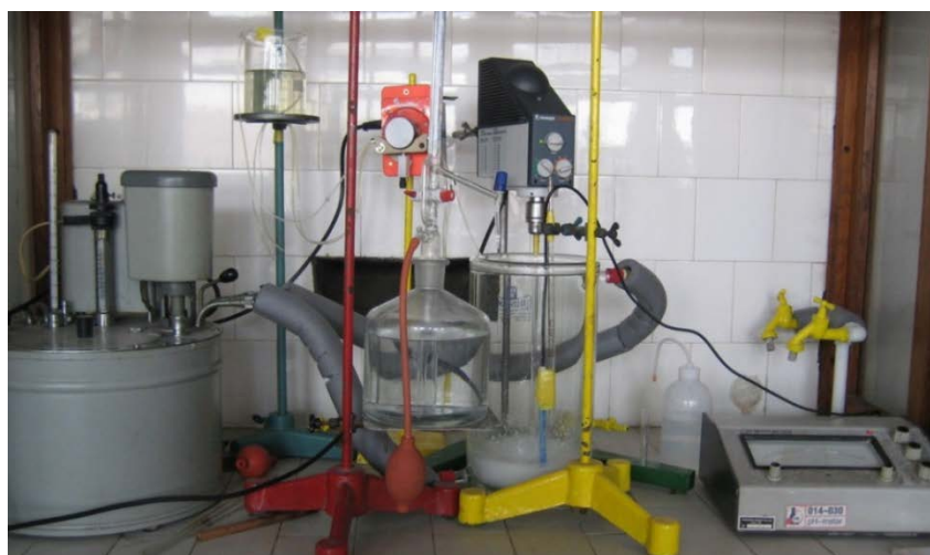
Slika 34 Aparatura za sintezu ZnAl-LDH slojevitih hidroksida
