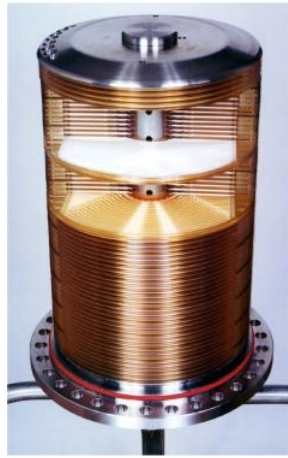
Slika 3.4. Modul sa ravnom membranom
