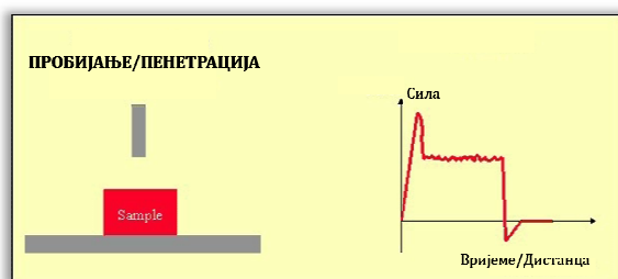
Слика 3.6 – Тест пробијања/пенетрације
