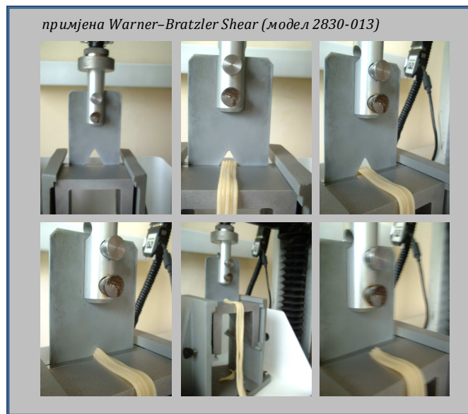
Слика 4.4 – Поступак теста расјецања на Инстрону – 4301
