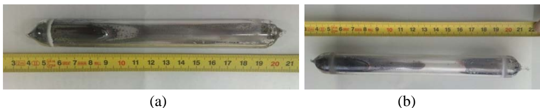
Slika 2.6. Izgled ampule sa sintetisanim amorfnim materijalom nakon vađenja iz glinice za uzorke sa (a) x = 1 at. % Ag i (b) x = 3 at. % Ag
