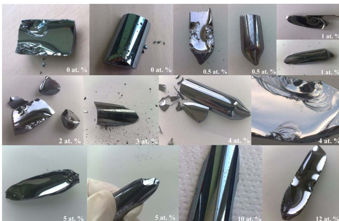
Slika 2.8. Izgled sintetisanih uzoraka iz sistema Ag_x(As_{40}S_{30}Se_{30})_{100-x} , x \leq 12 at. % Ag
