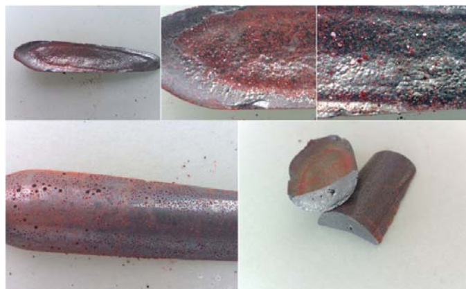
Slika 2.9.b Izgled sintetisanog uzoraka x = 15 at. % Ag, sa njegovim prelomima
