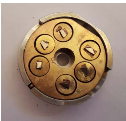
Slika 2.12. Nosač sa postavljenim uzorcima iz Ag-As-S-Se sistema, napareni 24 karatnim zlatom
