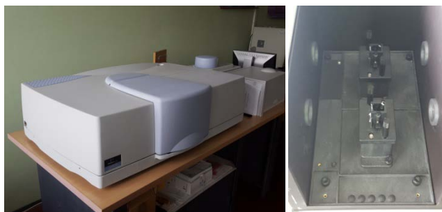
Slika 4.1. Izgled UV/VIS/NIR Perkin-Elmer spektrofotometra, model Lambda-950 (levo) i unutrašnjost komore za uzorke sa držačima (desno)
