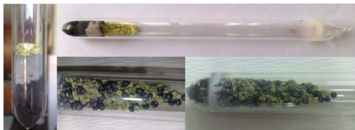
Slika 2.2. Ampule ispunjene sa elementarnim komponentama nakon završetka punjenja
