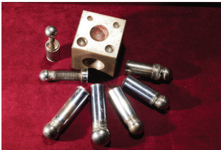
Foto 4.4 Sprava "srmenčeš" sa različitim profilima i promerima, za dobijanje filigranske žice
