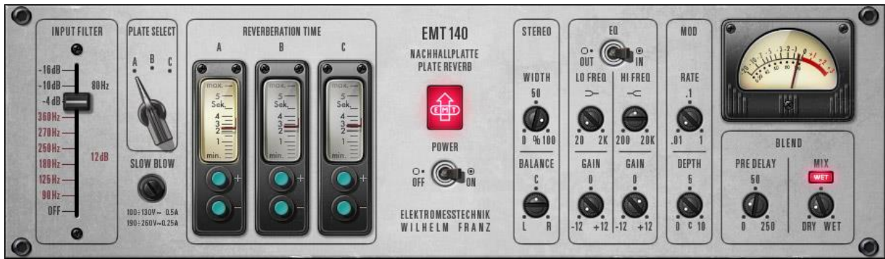
Slika 13: EMT 140, plug-in simulacija uređaja za veštačku reverberaciju
