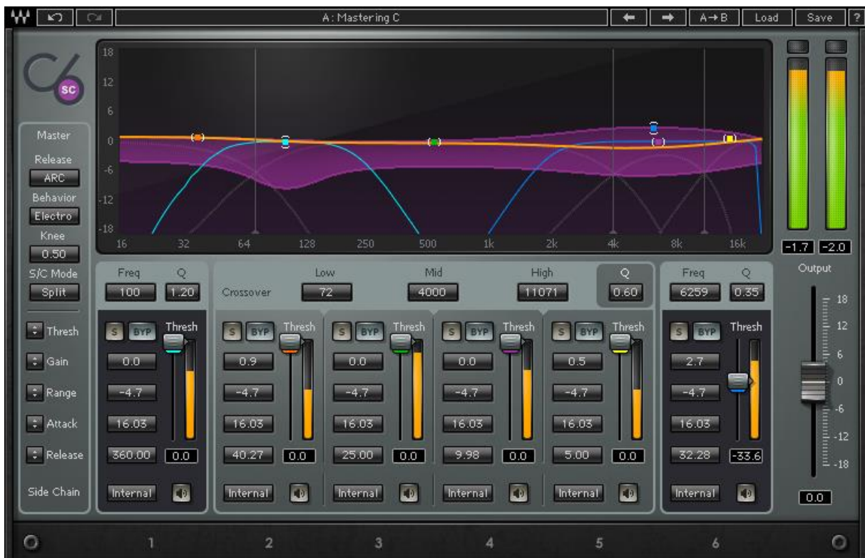
Slika 14: Waves C6, višepojasni dinamički procesor zvuka (VST plug-in)
