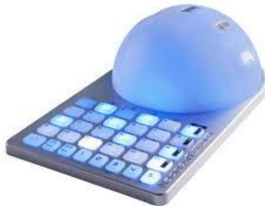
Slika 23: Naonext Crystal Ball, koji ima optičke senzore za prevođenje pokreta u MIDI podatke
