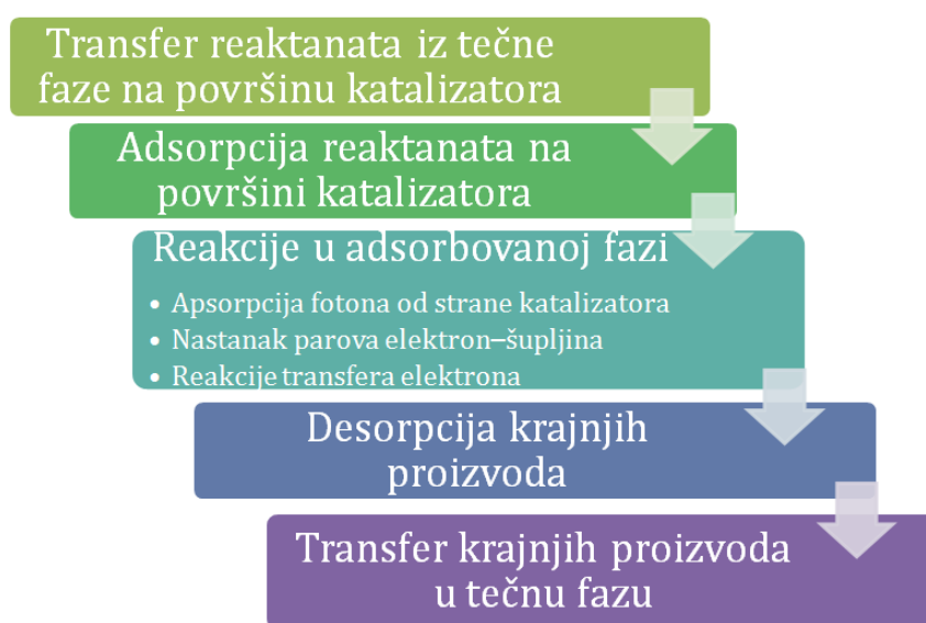
Slika 2.5. Proces heterogene fotokatalitičke reakcije prikazan u pet koraka (Herrmann, 2010)
