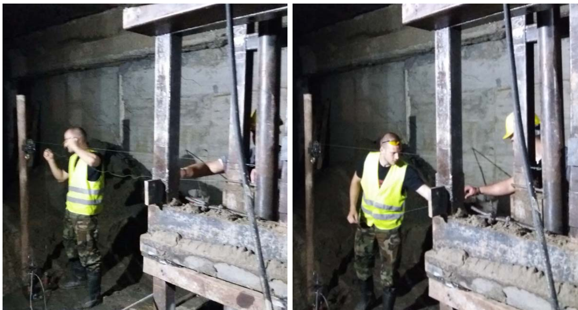
Slika 3.5 Postavljanje ugibomera za merenje horizontalnih pomeranja uzoraka
