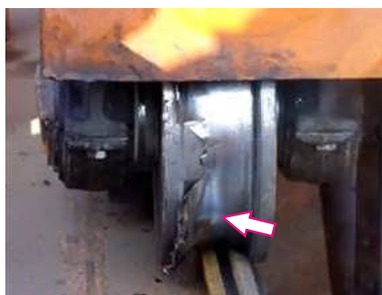
Sl. 1.7 Specifičan oblik slojevitog ljušpanja kotrljaljne površine točka, [265]
