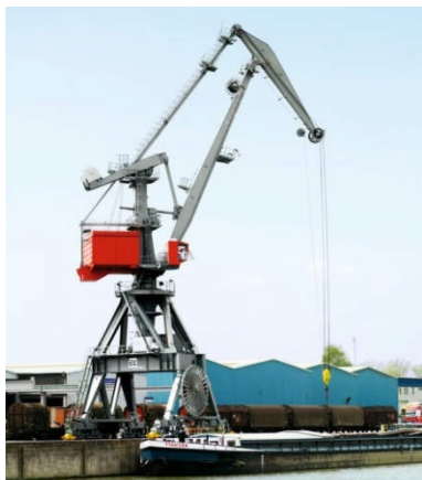
a) portalna obrtna dizalica sa nagibnom strelom i H-portalom, Ardelt , Nemačka, [257]
