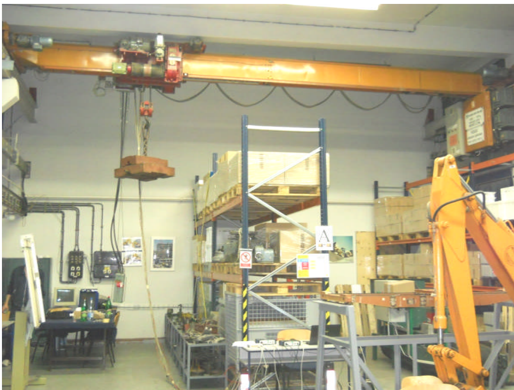
Sl. 4.22 Merenje bočnih sila na vertikalnim točkovima jednogrede mosne dizalice
