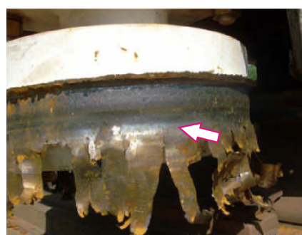
Sl. 1.8 Ljušpanje kotrljaljne površine vodeće rolne dizalice, [169]
