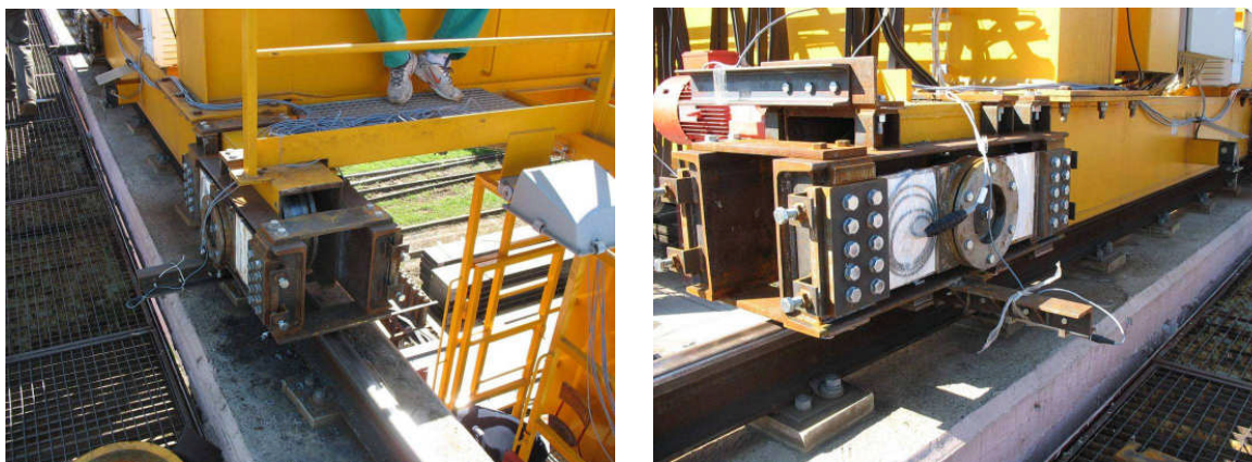
Sl. 2.9 Merenje bočnih sila na dvogrednoj mosnoj dizalici pomoću specijalnih sklopova točkova, [170]
