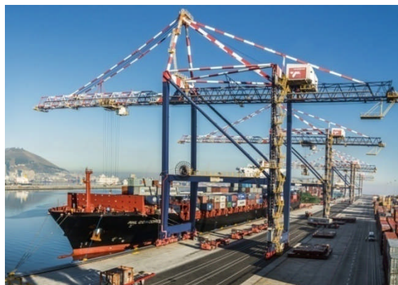
b) kontejnerska portalna mosna dizalica, Liebherr Container Cranes , Irska, [258]
