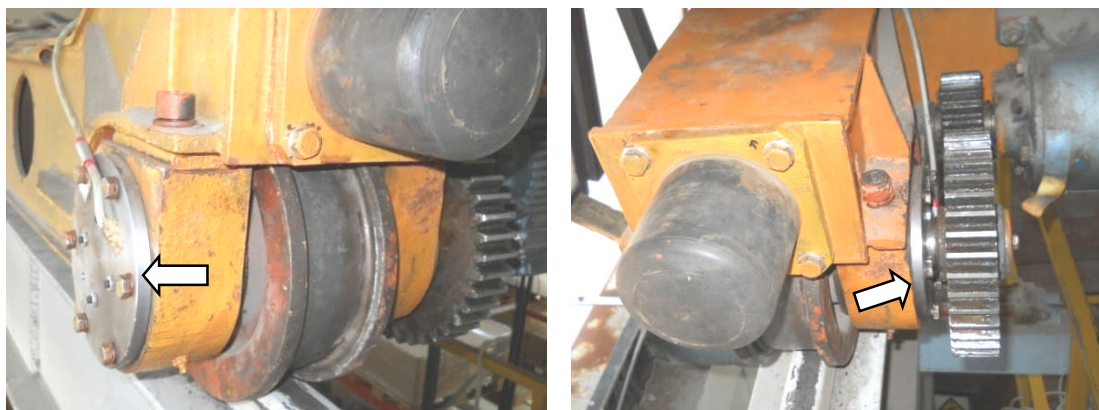
Sl. 4.21 Davači tipa DT ugrađeni u uležištenja pogonskog točka na levom bočnom nosaču
