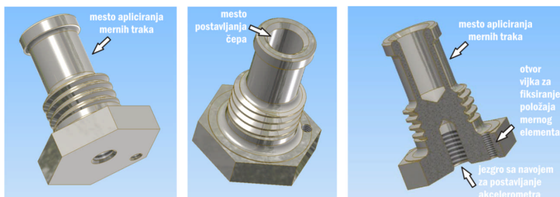
Sl. 4.13 Detalji mernog elementa davača tipa DV
