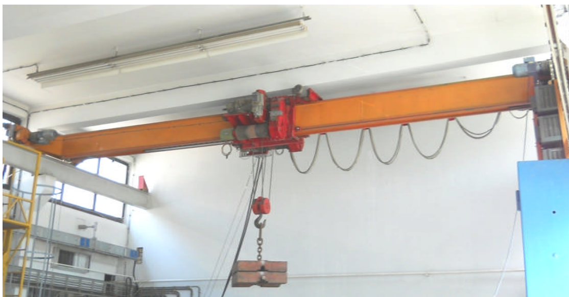
Sl. 4.1 Jednogreda mosna dizalica sa elektromotornim pogonima (FTN, Laboratorija za mašinske konstrukcije, transportne i građevinske mašine)
