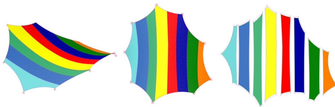
16 – Razdvajanje membrane na dvodimenzionalne isečke
