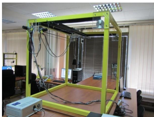
Slika 8.3 Laboratorijski model 3D kрана
