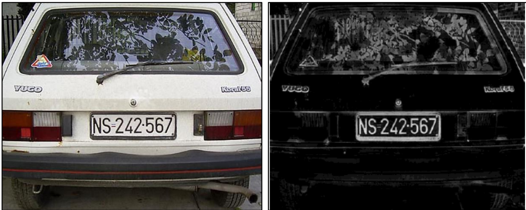
Slika 2.3. (a) Originalna slika, (b) rezultat bottom hat transformacije
