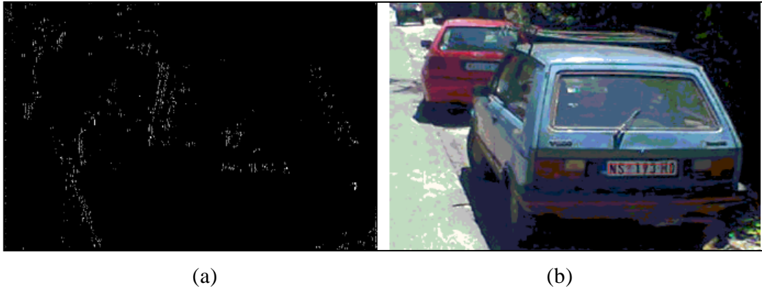
Slika 5.5. (a) Slika sa vertikalno detektovanim ivicama i (b) detektovana registarska tablica u polaznoj slici
