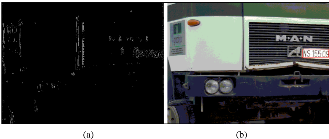
Slika 5.11. (a) Slika sa vertikalno detektovanim ivicama i (b) detektovana registarska tablica u polaznoj slici
