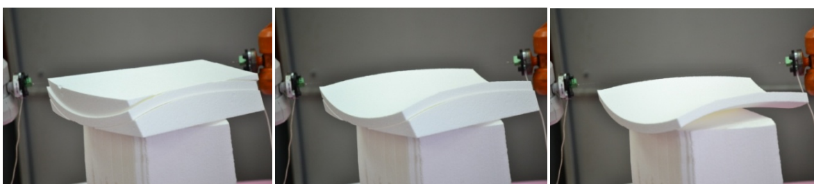
Slika 71 - sa leva na desno - proces uklanjanja nepotrebnih delova polistirena nakon izvršene druge putanje kako bi se dobio finalni prototip
