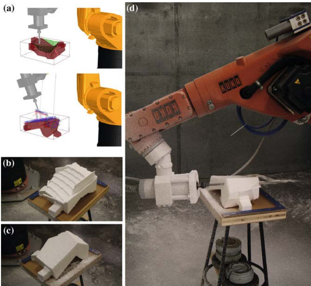
Slika 12 - Glodanje penastog polistirena primenom industrijskog robota a) simulacija b) prvi prelaz obrade elementa - gruba obrada, c) drugi prelaz obrade elementa - fina obrada, d) glodanje žljeba za povezivanje (Preuzeto Jung et al, 2016)
