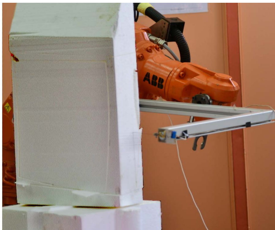
Slika 68 - gore - isecanje dodirnih strana bloka polistirena i elementa unutar njega uz postavku distancera za sprečavanje spuštanja bloka; dole - isecanje prednje i zadnje strane bloka, radi dobijanja identičnog modela bloka za drugu fazu sečenja
