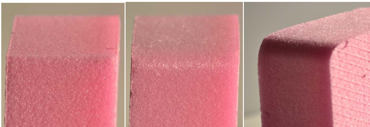
Slika 75 levo - prikaz odsečene strane XPS 30 materijala termalnim sečenjem; sredina - prikaz odsečene strane XPS materijala termo-mehaničkim sečenjem; desno - pojava zaobljenih ivica usled krivljenja žice
