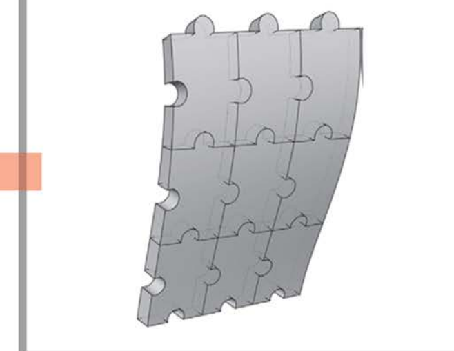
Podela površi na elemente slične puzlama
