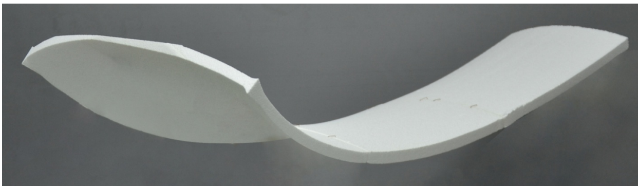
Slika 72 - prikaz tri spojena elementa, koji pokazuju nenarušenu neprekidnost zakrivljenosti površi i neprimetnu spojnicu između elemenata
