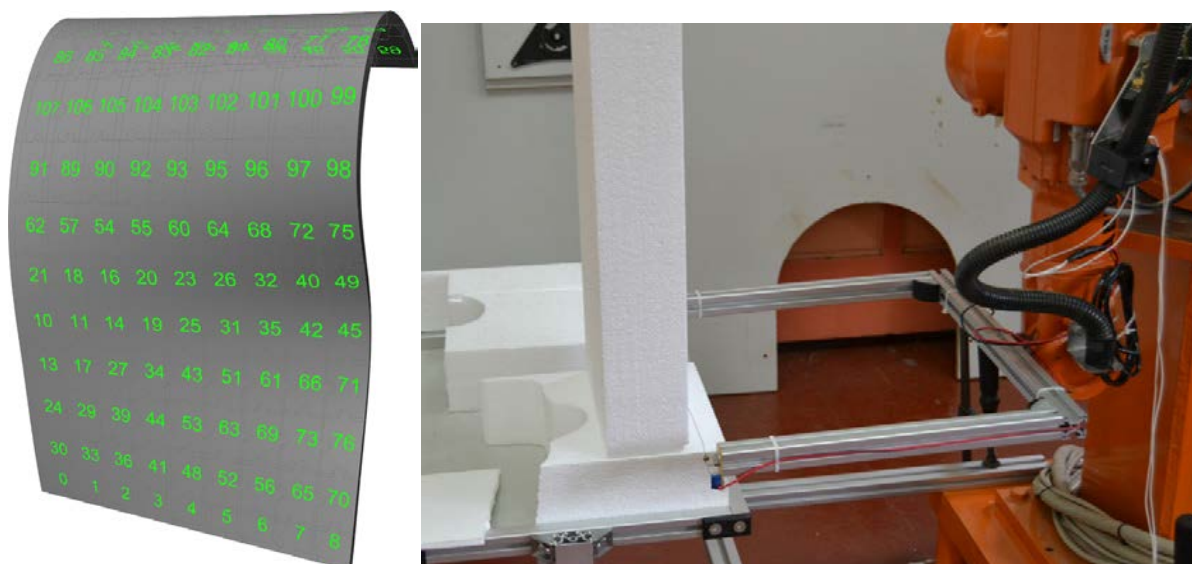
Slika 25 - Levo - pravoizvodna površ podeljena na numerisane elemente; desno - pozicija alatke za sečenje na početku prve putanje sečenja
