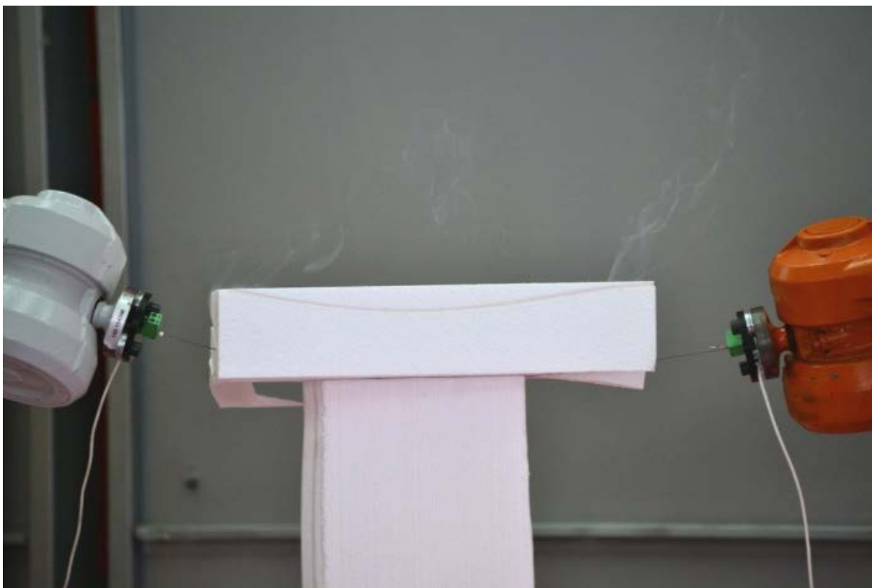
Slika 70 - Prikaz žice razvučene između alata robota u procesu sečenja finalnog prototipa iz bloka polistirena
