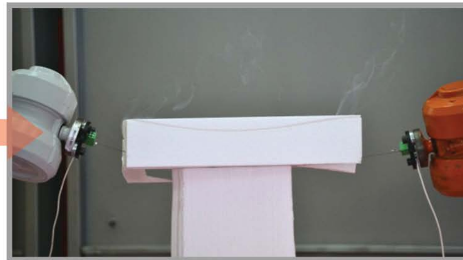
Realizacija procesa sečenja industrijskim robotom
