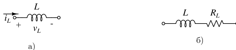
Слика 5.2: Индуктор као елемент са концентрисаним параметрима: а) идеалан, тј. без омских губитака и б) са омским губицима моделованим отпорником R_L
