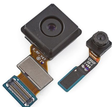
Slika 2.9. Izgled kamere koja se koristi u mobilnim telefonima. Primer za Samsung Galaxy S5 (Techspot, 2017a)
