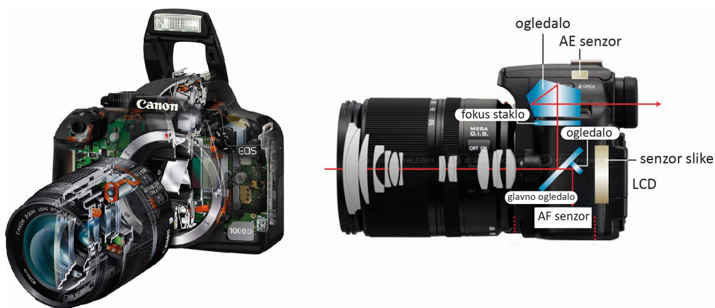
Slika 2.7. Poprečni presek digitalnih fotoaparata (Yunoinfo, 2017)
