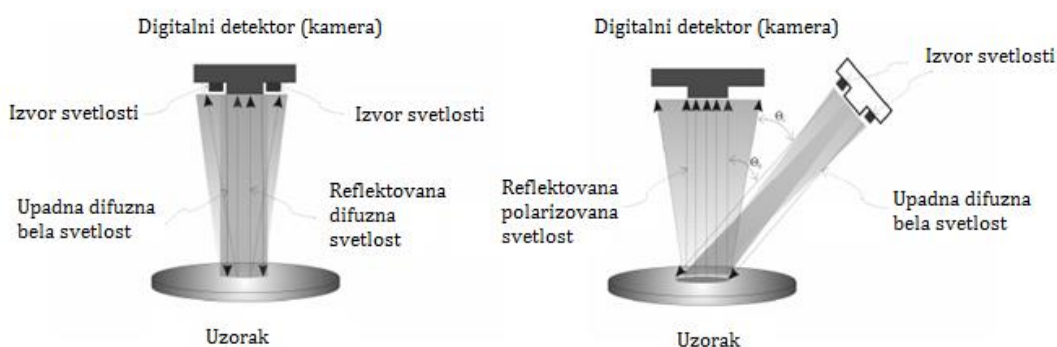
Slika 5.1 Prikaz relativnih pozicija izvora svetlosti za belu difuznu (levo) i reflektovanu polarizovanu svetlost (desno). Stepenn polarizacije svetlosti je 95.4%, dok je razlika između uglova \theta i \theta_1 \pm 1:6^\circ (šest belih LED dioda postavljeno je u krug) [78, 80]
