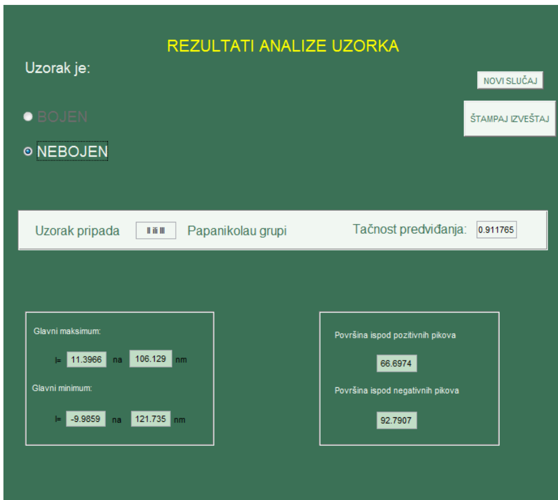
Slika 7.48 Prikaz trećeg panela GUI rešenja za OMIS uređaj koji daje rezultat klasifikacije uzorka, tačnost predviđanja i vrednosti OMIS parametara od značaja
