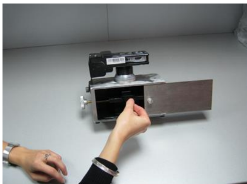
Slika 5.2 Uređaj B53 razvijen na Mašinskom fakultetu, u Nanolabu – laboratoriji za Biomedicinsko inženjerstvo, koji se koristi za primenu Optomagnetne imidžing spektroskopije u ranoj dijagnostici kancera epitelnog tkiva
