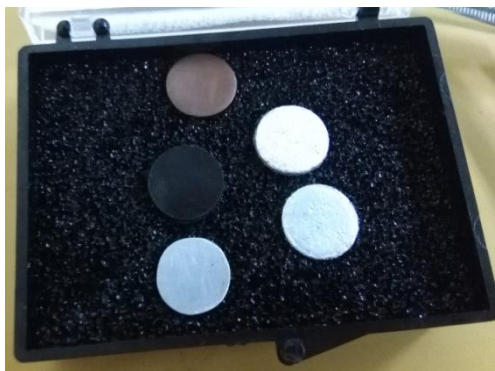
Слика 26 Пет узорака за упоредна испитивања: бакар од 500 \mu\text{m} , алуминијум од 295 \mu\text{m} , АБС од 920 \mu\text{m} и два узорка од полиамида дебљине од 950 \mu\text{m} и 370 \mu\text{m} ,
