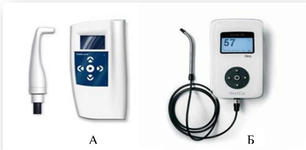
Слика 1.8 А) Osstell® Mentor и Б) Osstell ISQ® ( Integration diagnostics AB , Гетеборг, Шведска).
