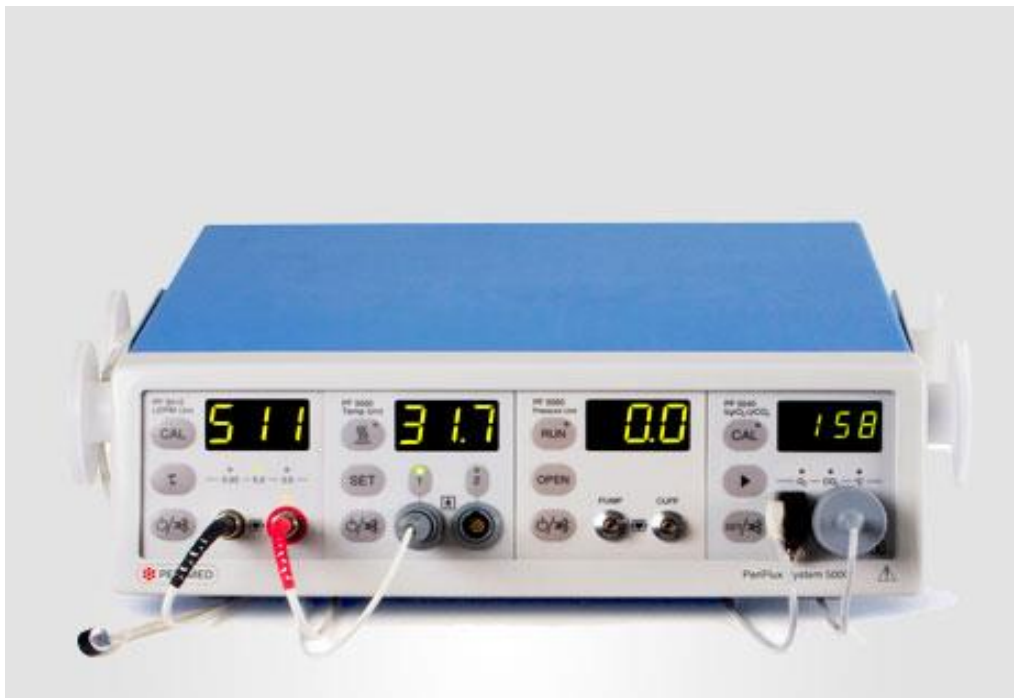
Слика 3.8 Ласер доплер флоуметар Perifluks PF 5001 Masters
