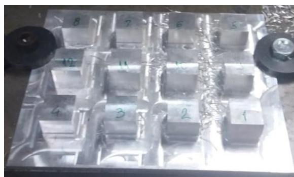
Слика 10.33. План обраде изданака и обрађен део
