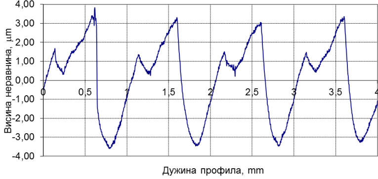
Слика 10.34-а. Топографија бочне површине изданка 3
