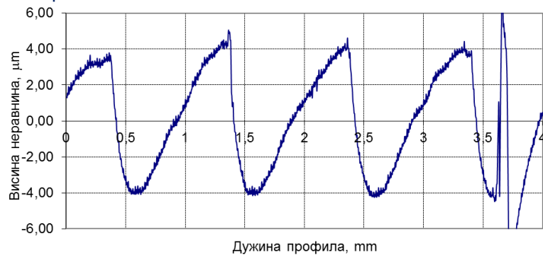
Слика 10.34-з. Топографија бочне површине изданка 19
