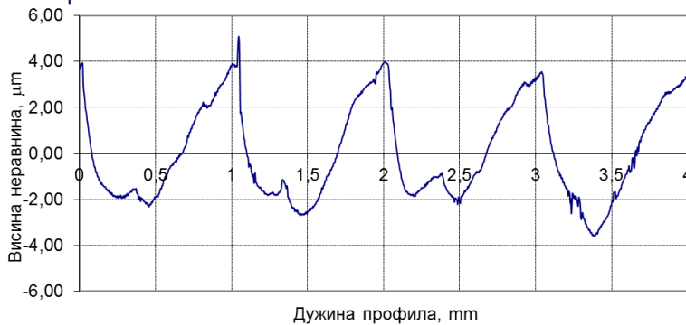
Слика 10.34-е. Топографија бочне површине изданка 15
