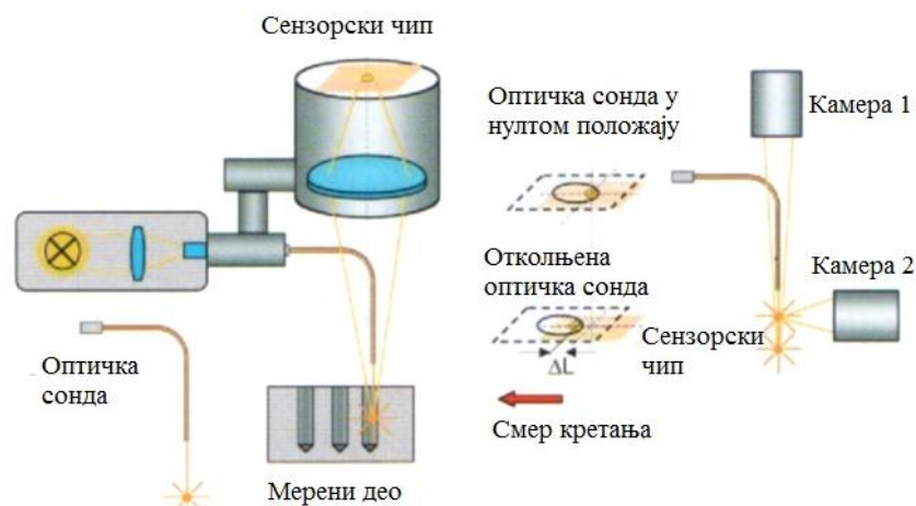
Слика 4.11. Принцип рада оптичке сонде [137]
