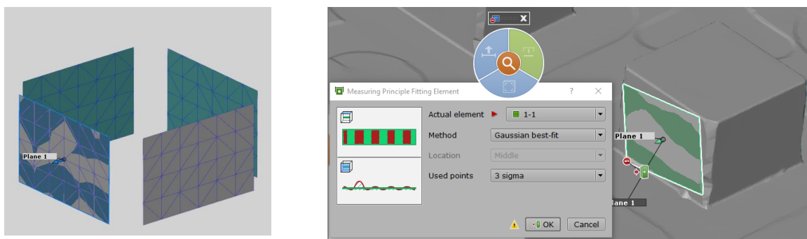
Слика 11.18. Апроксимирање равни површине изданка за SMM и скениран облак
