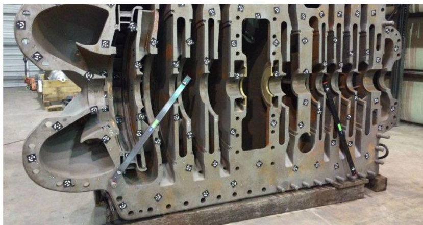
Слика 5.5. Фотограмметријске ознаке на делу [156]
