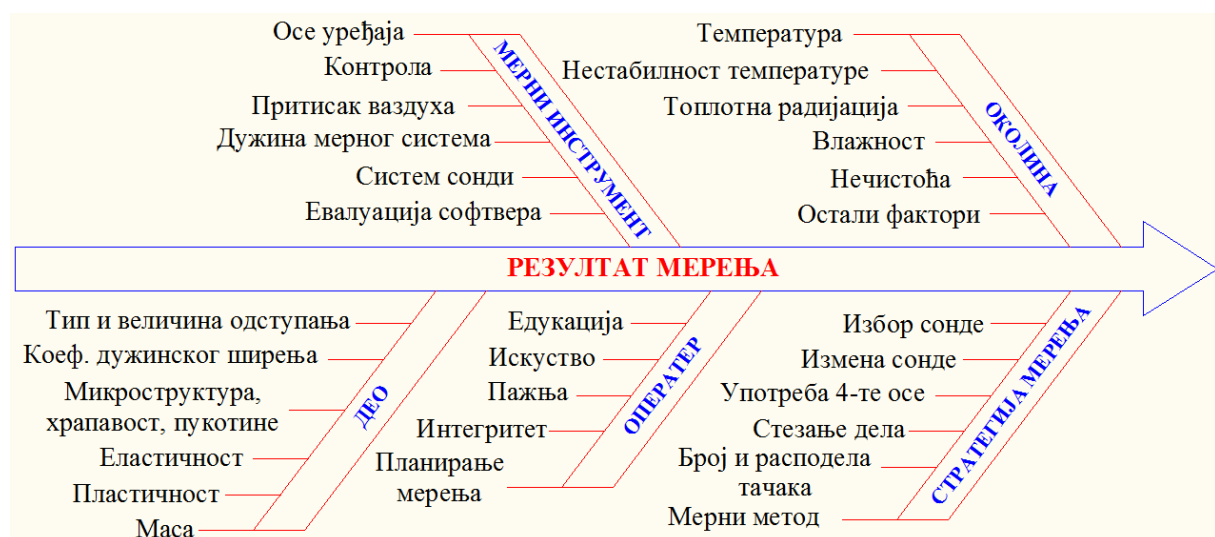
Слика 4.20. Утицај различитих фактора на мерну несигурност СММ [143]
