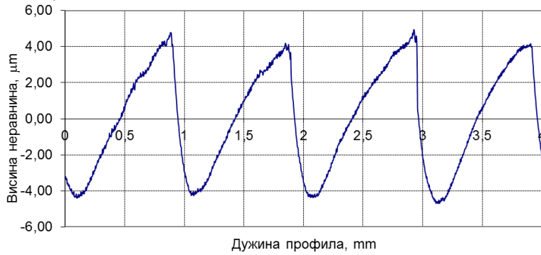
Слика 10.34-в. Топографија бочне површине изданка 7
