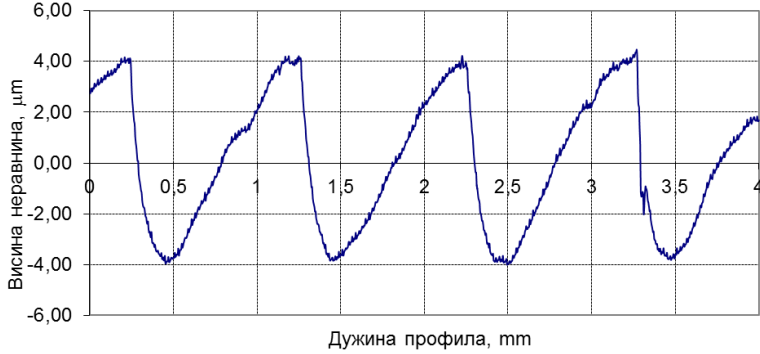
Слика 10.34-д. Топографија бочне површине изданка 11
