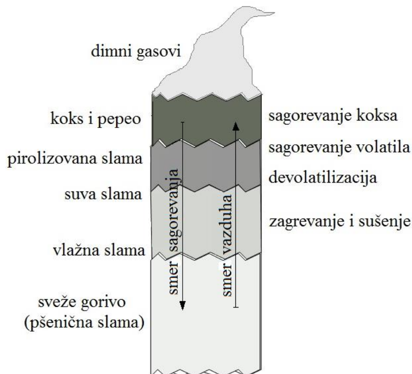
Slika 3.3: Faze procesa sagorevanja pšenične slame u nepokretnom sloju (Čepić et al., 2017a)
