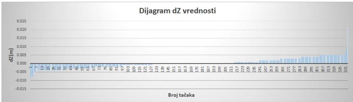
SLIKA 6.15: Prikaz odstupanja kontrolnih tačaka od LiDARMmCP modela
