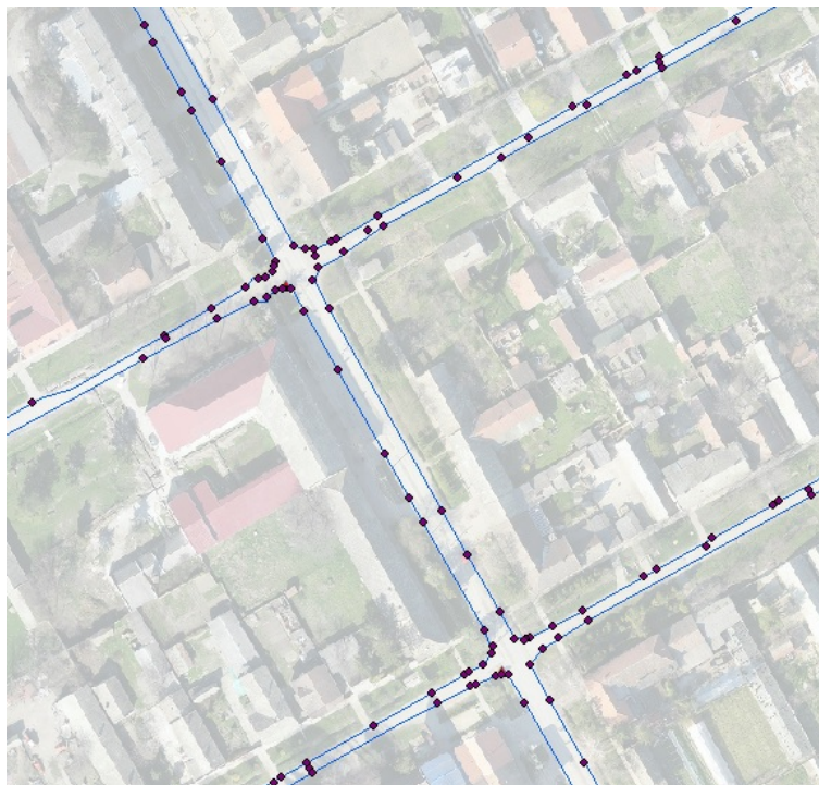
SLIKA 5.13: Precizna elektronska tahimetrija, izdvojene tačke unutar definisanog poligona ulica
