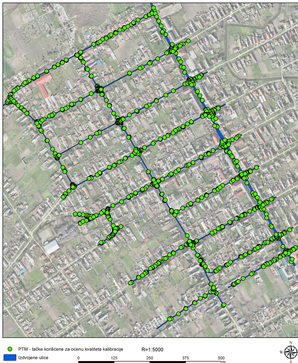
SLIKA 7.1: PTM - izdvojene tačke za potrebe ocene kvaliteta kalibrisanih podataka (ukupno 961 tačka)
