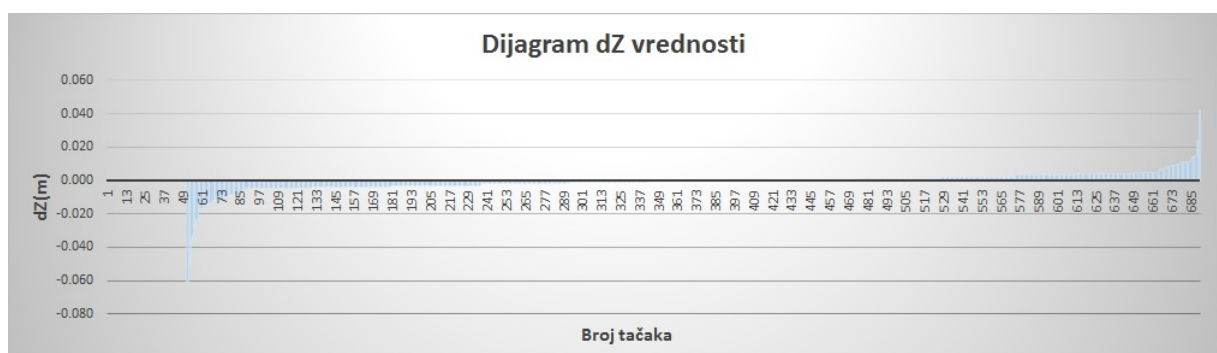
SLIKA 6.13: Prikaz odstupanja kontrolnih tačaka od kalibriranog UAVMmCP modela
