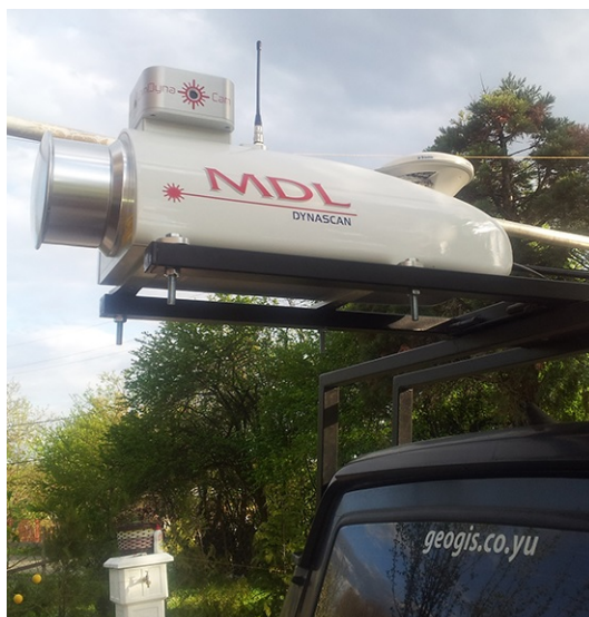
SLIKA 1.25: „MDL DynaScan S250" sistem montiran na vozilo
