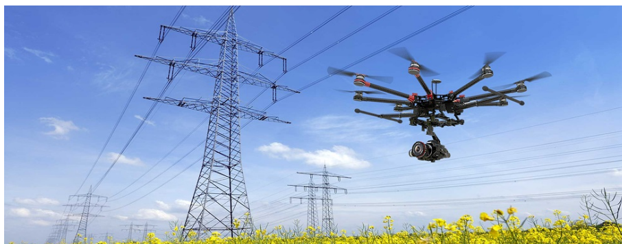
SLIKA 3.19: Inspekcija trase dalekovoda UAV sistemom
