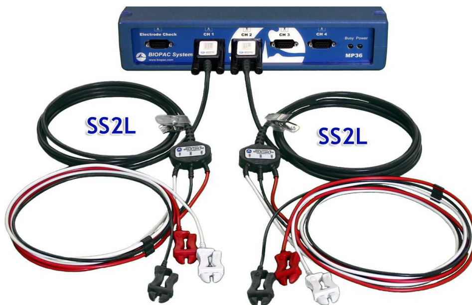
Слика 4.6. Повезивање оловних електрода и аквизиционе јединице: за хоризонтално снимање канал 1 ( CH 1 ), за вертикално снимање канал 2 ( CH 2 )
