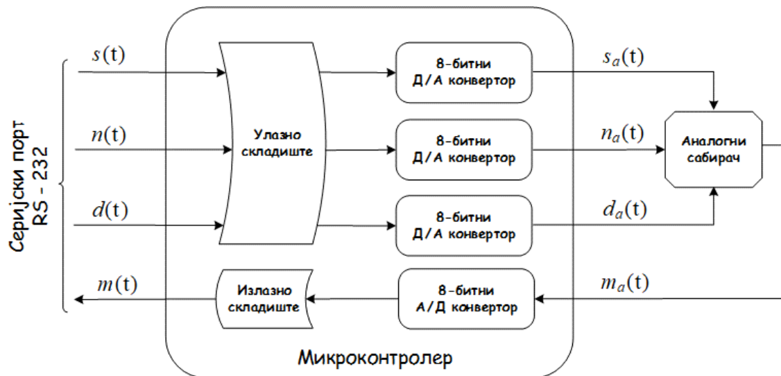
Слика 7.2. Функционална блок-шема штампане плоче повезане са рачунаром
