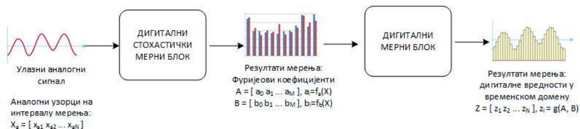
Слика 5.12. Концепт мерења нестационарног сигнала у временском домену стохастичким дигиталним мерењем у току једног мерног интервала
