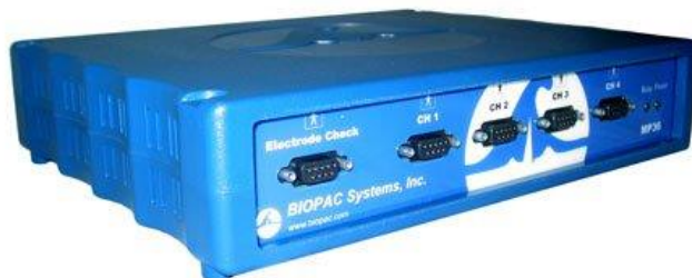
Слика 4.4. Хардверски део BIOPAC система: четворо-канална јединица за аквизицију података MP36 – предња страна
