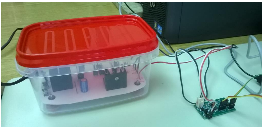
Слика 7.8. Експериментална штампане плоча повезана са стабилисаним напајањем
