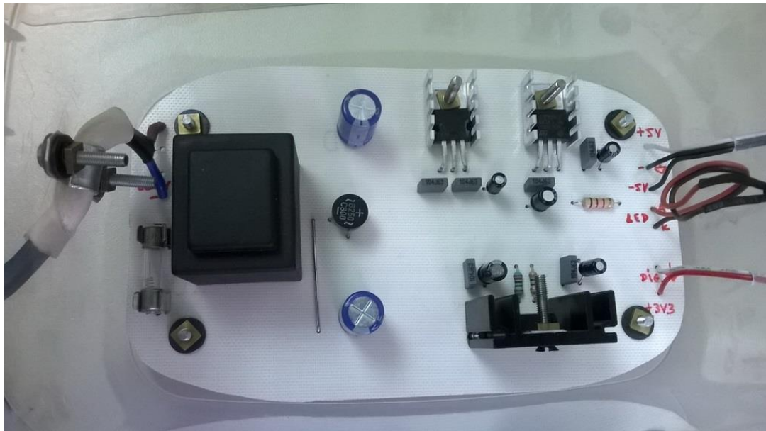
Слика 7.7. Екстерно напајање штампане плоче са стабилисаним излазним напонима од 3,3 V и +/- 5 V
