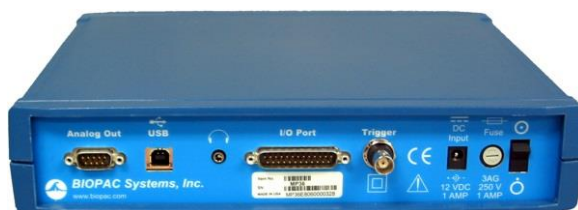
Слика 4.5. Хрдверски део BIOPAC система: четворо-канална јединица за аквизицију података MP36 – задња страна
