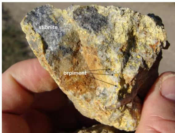
Slika 36. Stibnit i auirpiment u uzorku sa deponije jalovina rudnika Rujevac, (Fotografija Vakanjac B. 2013.)
