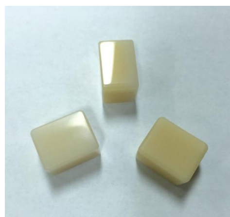
Слика 5.2 Приказ леуцитних блокова ( IPS Empress CAD ), а) изглед сировог материјала, б) изглед кристализованог леуцита
