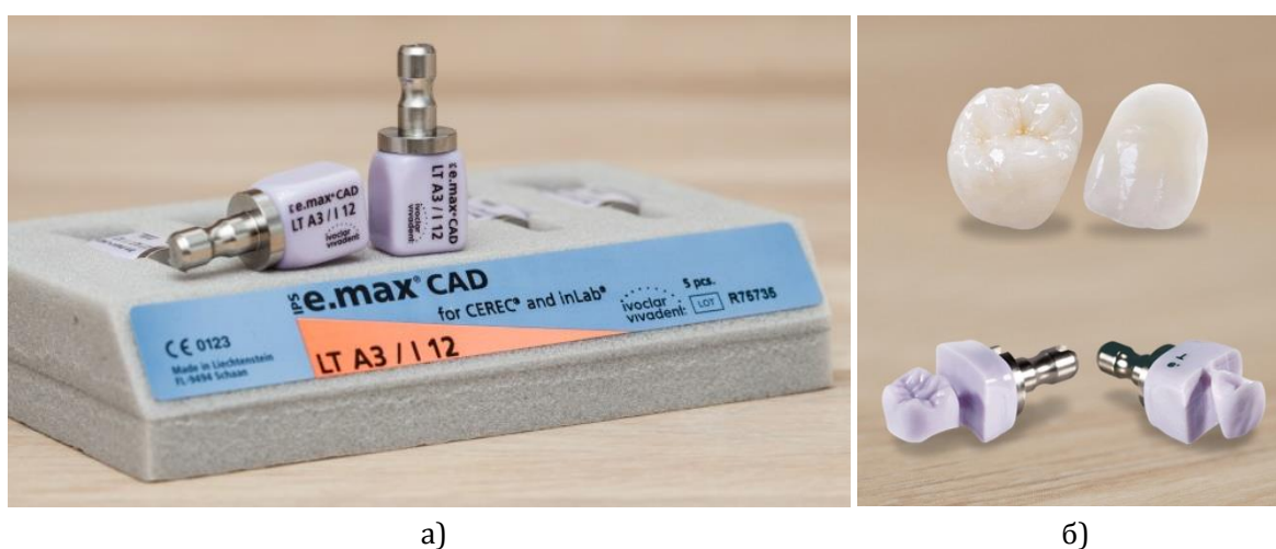
Слика 2.8 Приказ блокова литијум дисиликата ( IPS e.max CAD блокова), а) изглед сировог материјала, б) изглед кристализованог блока обрађеног CAD/CAM системом
