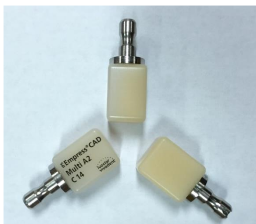
Слика 5.2 Приказ леуцитних блокова ( IPS Empress CAD ), а) изглед сировог материјала, б) изглед кристализованог леуцита
