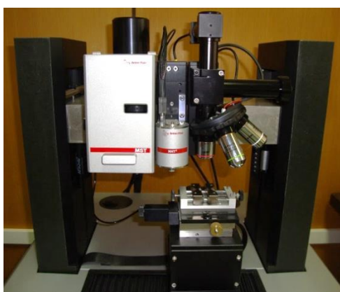
Слика 4.7 Изглед уређаја Anton Paar Nanoindenter & Micro Scratch Tester и принцип рада
