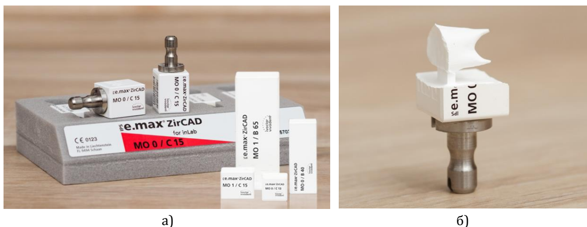
Слика 2.18 Приказ IPS e.max ZirCAD блока , а) изглед сировог материјала, б) изглед блока обрађеног CAD/CAM технологијом
