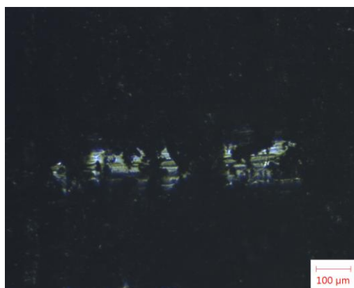
Слика 9 Оптички приказ трагова хабања комерцијалне фасетне керамике при различитим завршним обрадама, F_n=750 mN, v=8 mm/s: а) полирана површина (5×); б) глазирана површина (5×) и в) брушена површина (5×)
