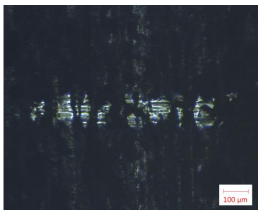
Слика 3 Оптички приказ трагова хабања комерцијалног литијум дисиликата при различитим завршним обрадама, F_n=750 mN, v=8 mm/s: а) полирана површина (5×); б) глазирана површина (5×) и в) брушена површина (5×)
