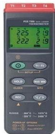
Slika 7.1. Četvorokanalni instrument za merenje temperature
