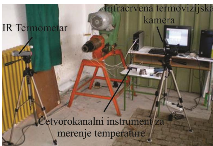
Slika 7.9. Izgled eksperimentalnog štanda sa instrumentima za merenje
