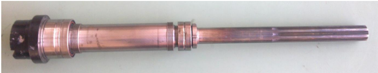
Slika 7.11. Izgled glavnog vretena sa ugrađenim ležajima
