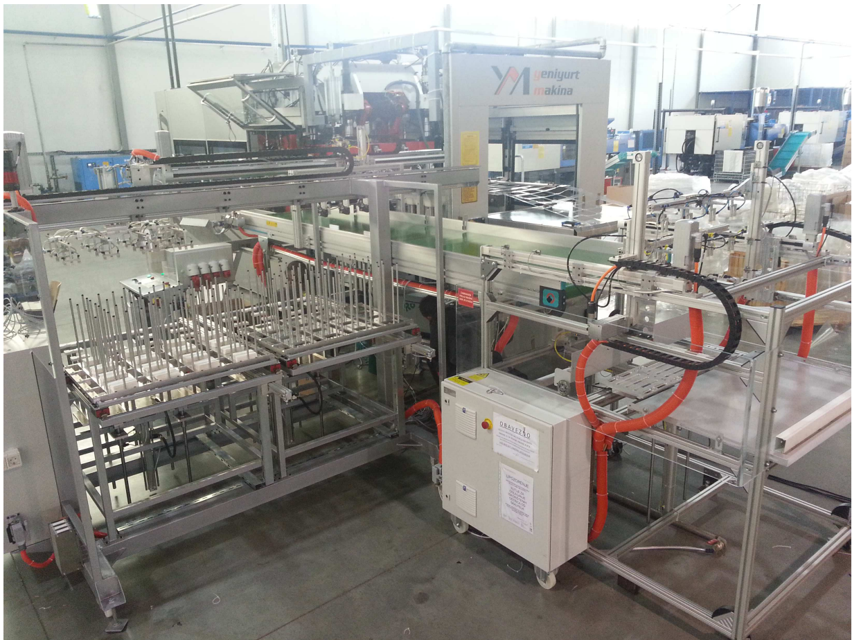
Slika 4.24 Proizvodno - montažni sistem (manipulatori za mašinu za termoformiranje)
