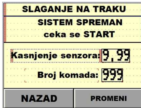
Slika 4.50 Izgled ekrana dipleja u automatskom radu i/ili podešavanje parametara manipulatora za izuzimanje plastičnih posuda
