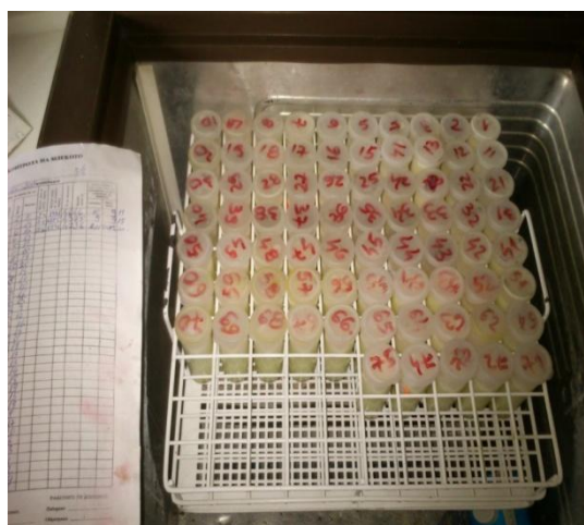
Slika 4.16. Stavljanje i čuvanje uzoraka mleka za analizu u zamrzivaču na -18\text{ }^{\circ}\text{C} i popratni dopis za identifikaciju uzoraka (foto: M. Ristevski, 2014).
