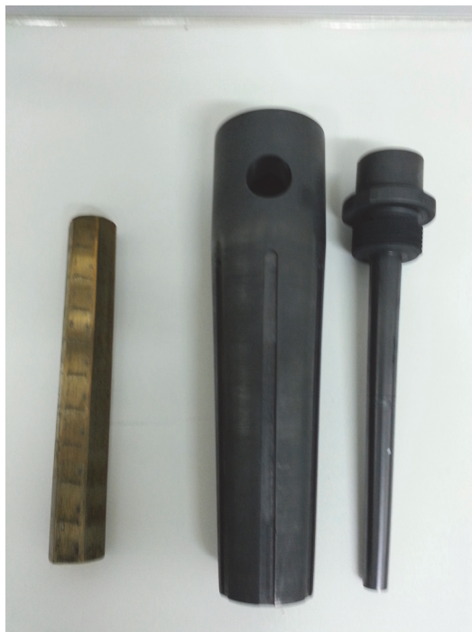
Slika. 2.135. Grafitna kokila za livenje šestougaone cevi, postupkom vertikalnog kontinualnog livenja na dole
