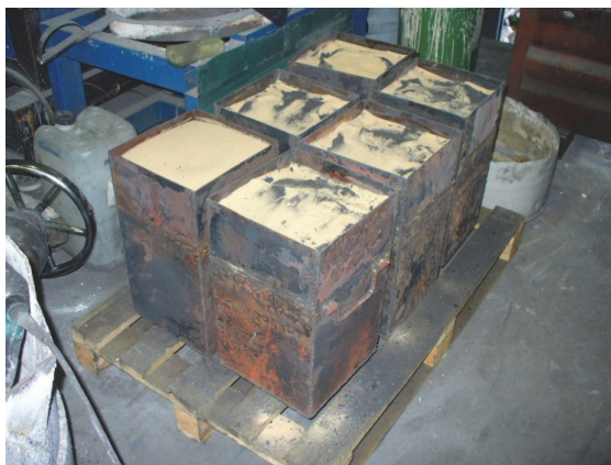
Slika 2.130. Sušenje betonske čaure
