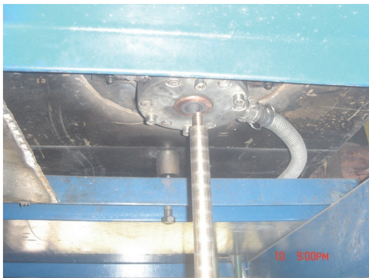
Slika 2.80. Postavljanje startne šipke
