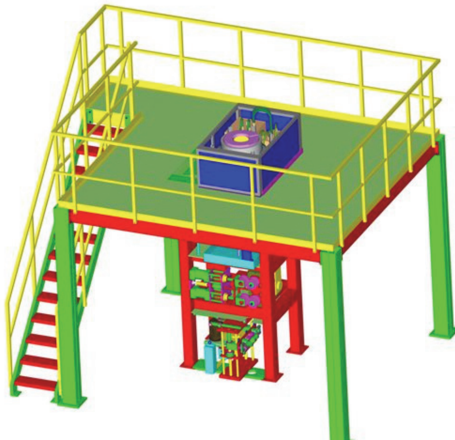
Slika 2.1. Postrojenje za vertikalno kontinualno livenje na dole
