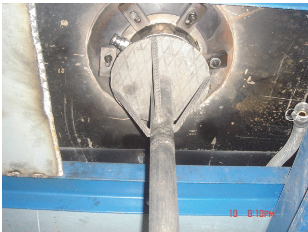
Slika 2.73. Fiksiranje kristalizatora za livni lonac na livnoj peći
