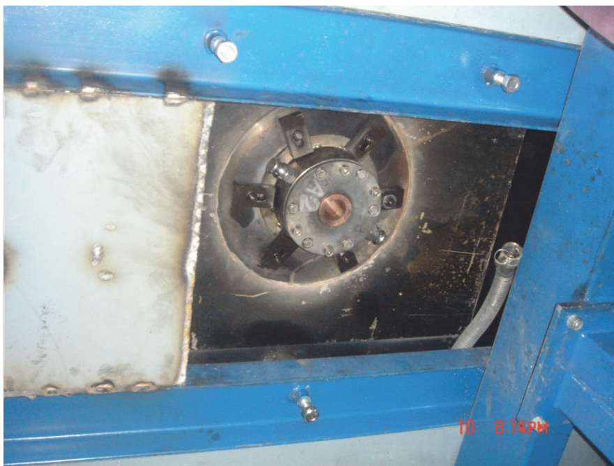
Slika 2.74. Uklanjanje nosača kristalizatora
