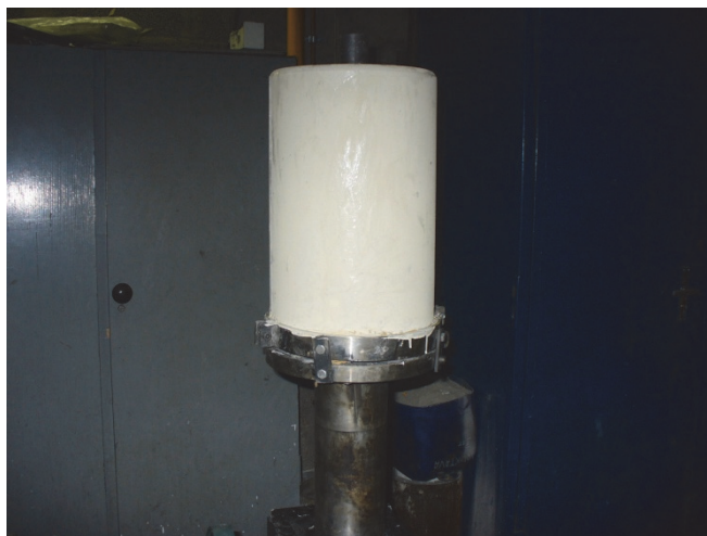
Slika 2.127. Zaštita betonske čaure premazom na bazi amonijum oksida
