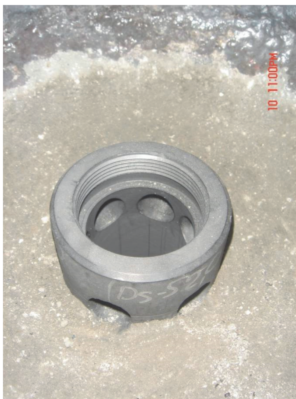
Slika 2.79. Nabijanje dna livnog lonca u slučaju livenja šupljeg profila
