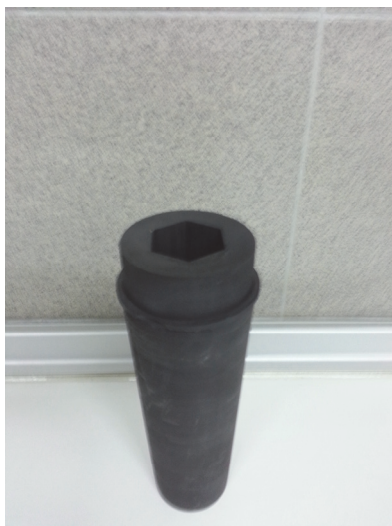
Slika 2.134 Grafitna kokila za livenje punog šestougaoanog profila postupkom vertikalnog kontinualnog livenja na dole
