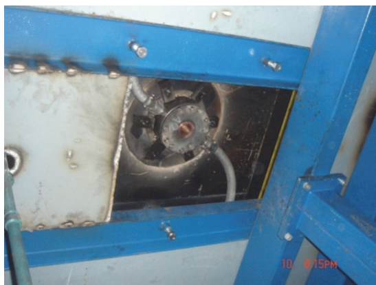
Slika 2.75. Povezivanje kristalizatora sa sistemom za hlađenje vodom
