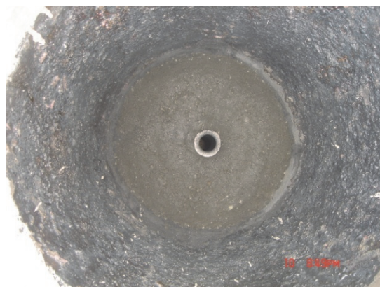
Slika 2.78. Nabijanje dna livnog lonca u slučaju livenja punog profila
