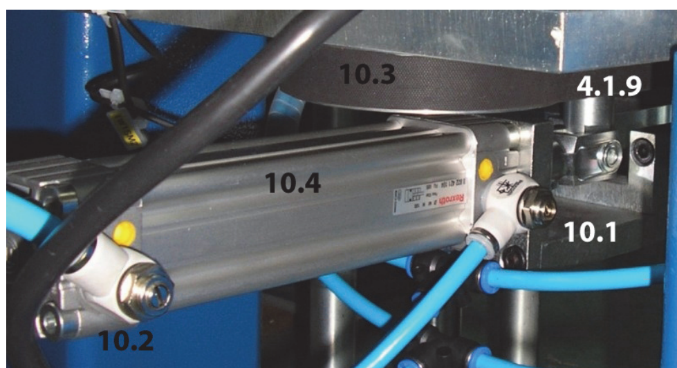
Slika 2.11. Pneumatski cilindar za horizontalno kretanje leteće cirkularne testere
