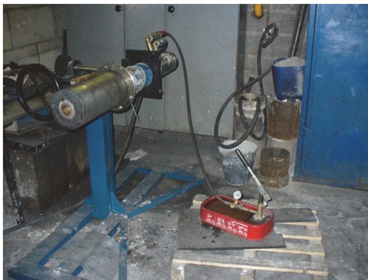
Slika 2.122. Provera kristalizatora na pritisak
