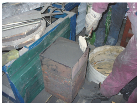
Slika 2.131. Prekrivanje grafitom betonske čaure
