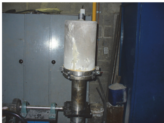
Slika 2.126. Montaža betonske čaure za kristalizator
