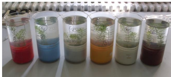
Slika 4.5. Test inhibicije rasta na vrsti Myriophyllum aquaticum u test sistemu voda-sediment
