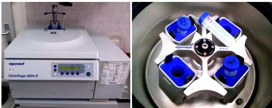
Slika 6. Centrifuga sa hlađenjem ili grejanjem Naučni institut za veterinarstvo u Novom Sadu, Odeljenje za reprodukciju
