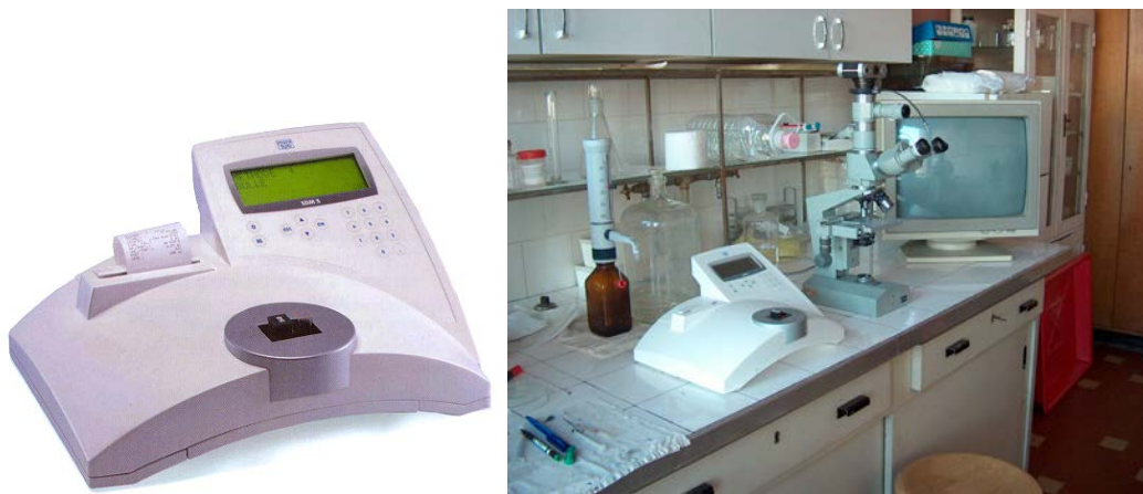
Slika 5. Fotometar SDM-5 za fotometrijsko brojanje spermatozoida ( levo ). Laboratorija za reprodukciju i VO domaćih životinja, Poljoprivredni fakultet, Novi Sad (desno)
