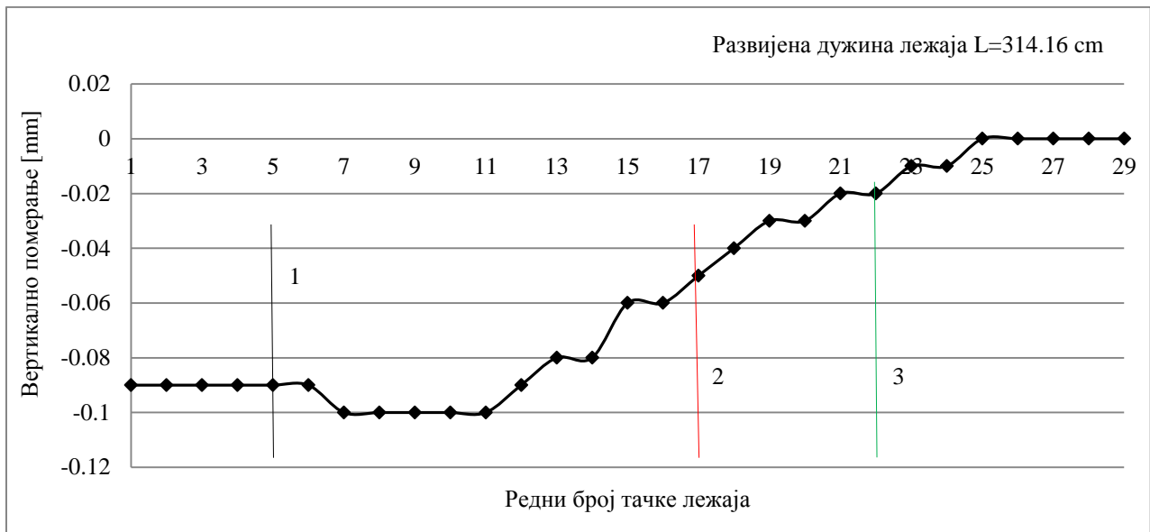
Слика 8.12 Вертикално померање тачака доње стазе лежаја, лабораторијски модел, редукована вертикална оптерећења
