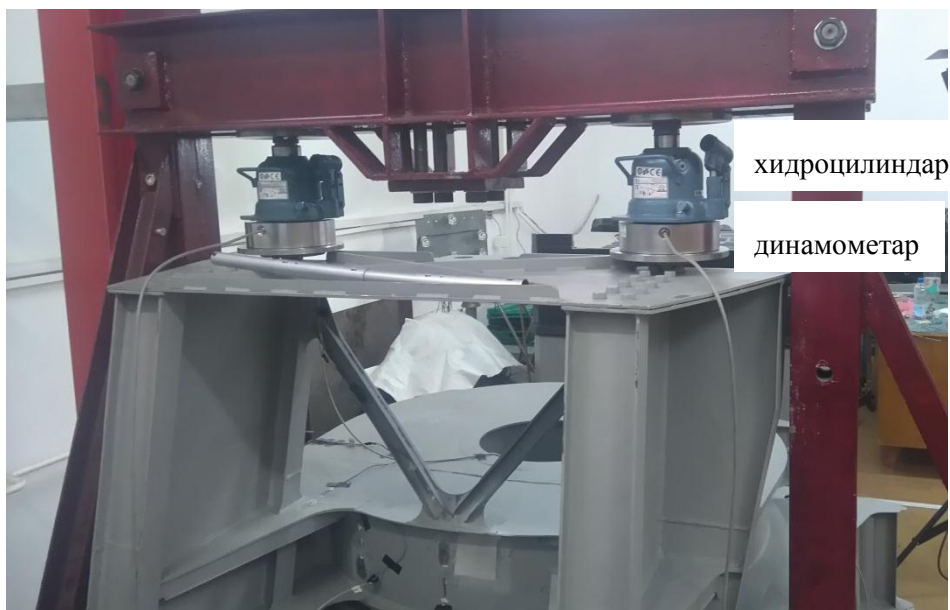
Слика 9.12 Унос оптерећења
