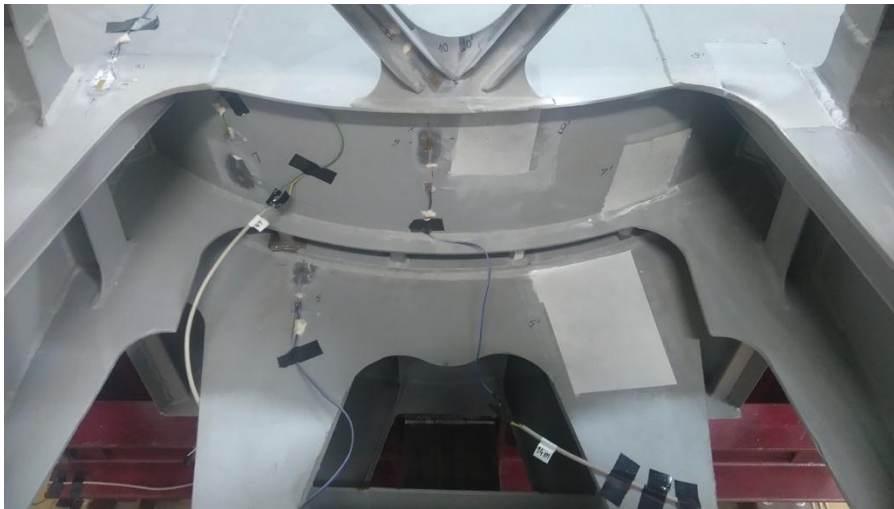
Слика 9.7 Локације мерних трака и коресподентних поља за снимање Системом за бесконтактно мерење померања и деформације
