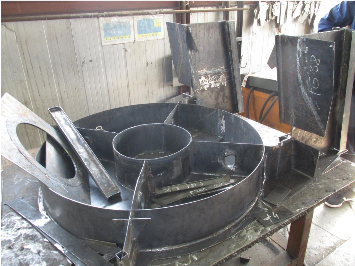
Слика 7.2 Обртна платформа у току израде, радионица Колубара-Метала
