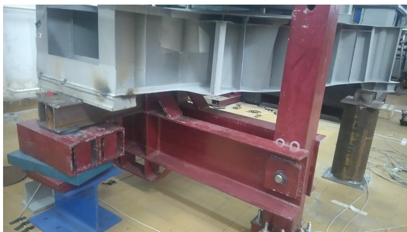
Слика 9.11 Позиционирање модела у раму за испитивање
