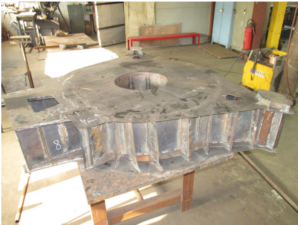
Слика 7.1 Доња градња у завршној фази израде, радионица Колубара-Метала
