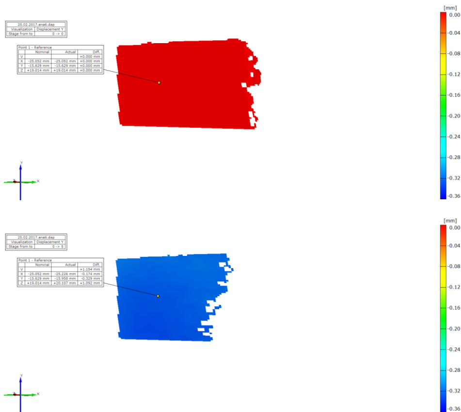
Слика 10.5 Поље вертикалних померања добијено системом за бесконтактно мерење померања и деформације, растерећено и крајње оптерећено стање, ММ 1-3
