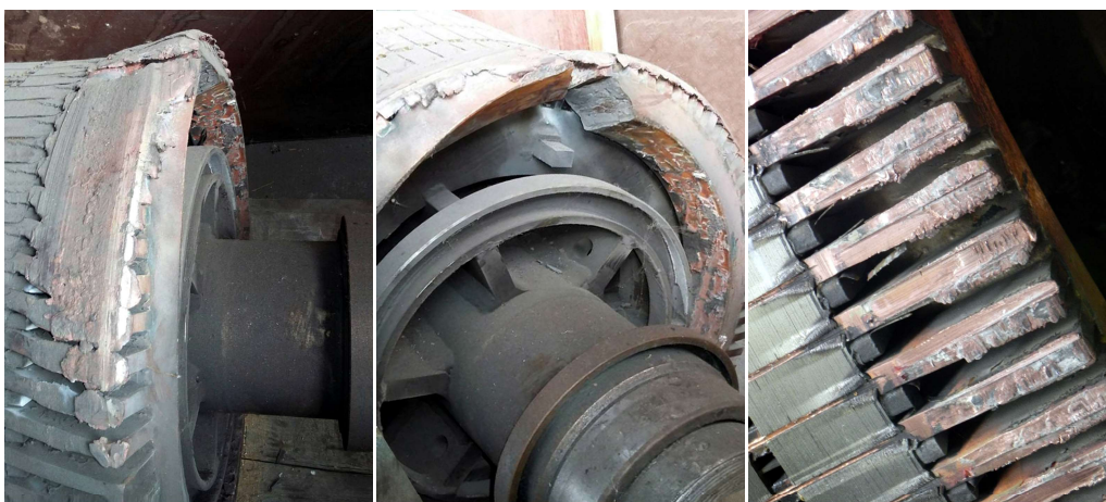
Slika 2.6 Fotografija trajnog oštećenja kaveza rotora.
