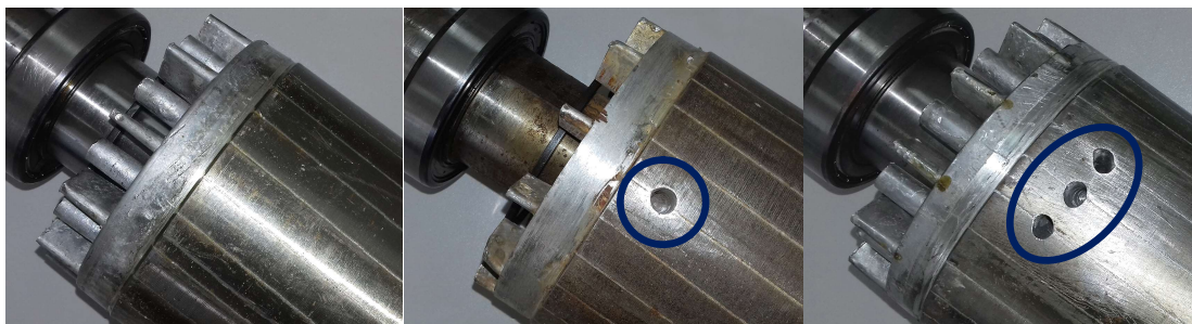
Slika 6.3 Ispravan rotor i rotor sa prekidom jednog i tri susedna štapna provodnika.
