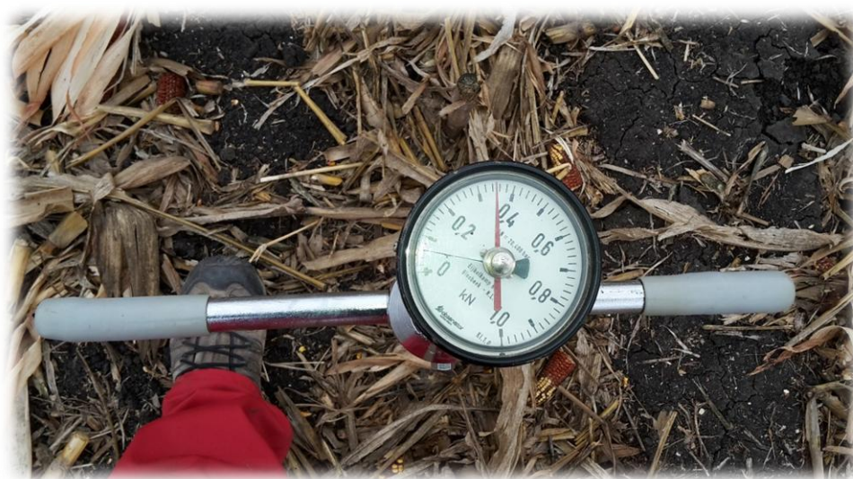
Slika 6.22 Merenje otpora zemljišta penetrometrom
