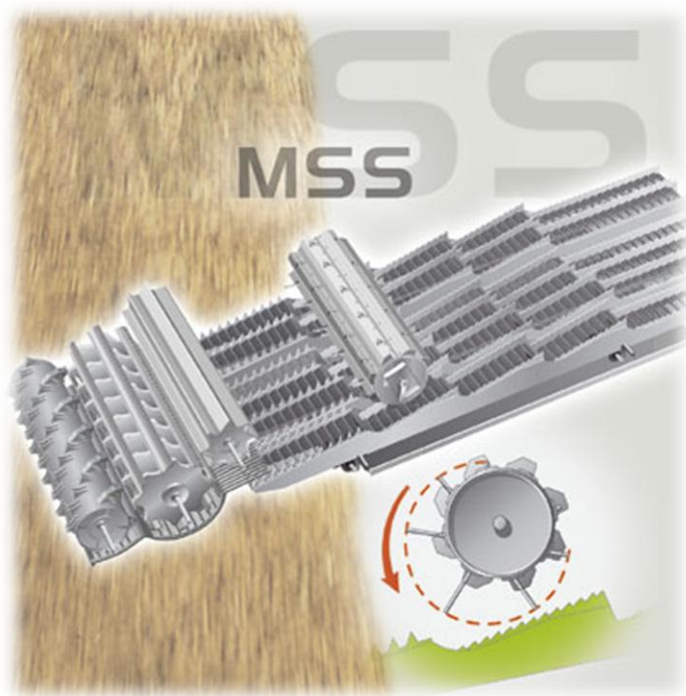
Slika 6.12 Tangencijalni vršidbeni sistem sa predbubnjem
