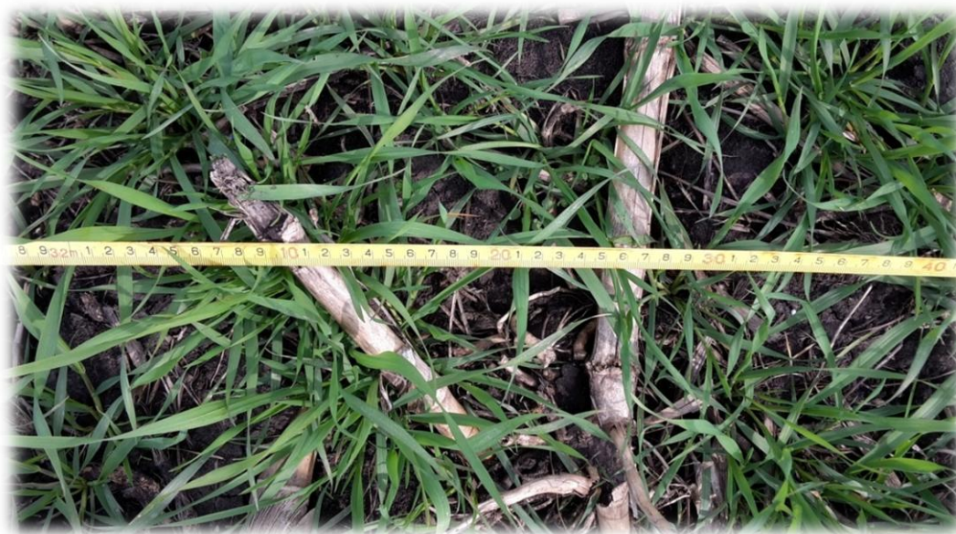
Slika 6.24 Linearni metod određivanja pokrivenosti biljnim ostacima
