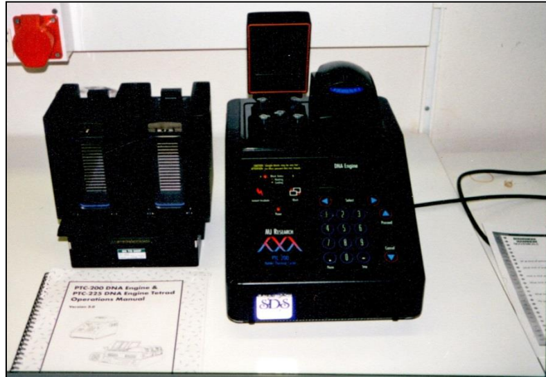
Slika 8. PCR mašina PTC-100 Programmable Thermal Controller (MJ Research Inc., Watertown, Mass.) korišćena za amplifikaciju fragmenata DNA cijanobakterija korišćenjem STRR prajmera (foto: Fojkar O.)
