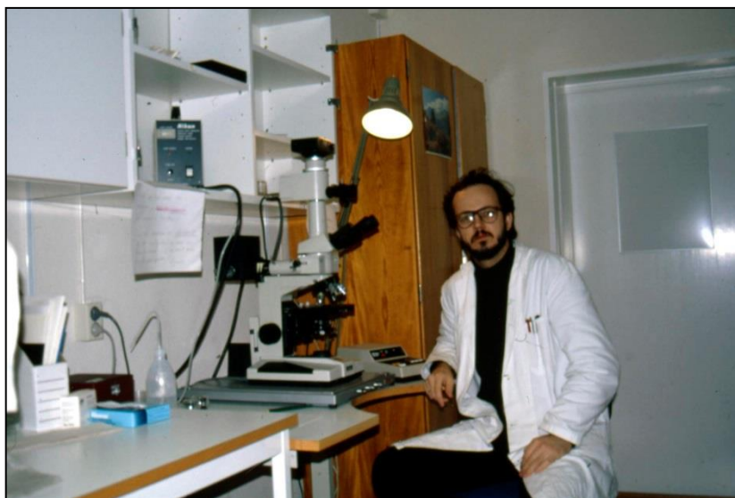
Slika 5. UV mikroskop primenjen za DAPI metod bojenja cijanobakterija
