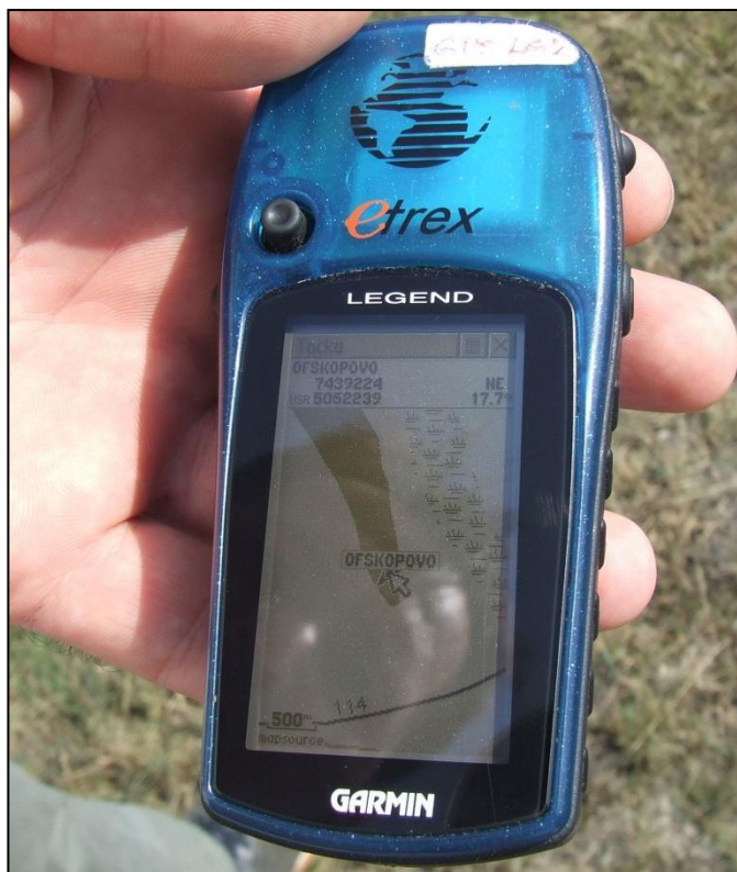
Slika 2. Uređaj GPS GARMIN ETREX za određivanje tačne geografske širine i g. dužine (foto Fojkar O.)
