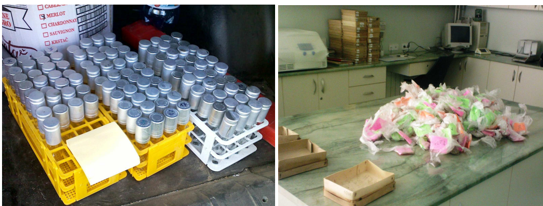
Slika 5.3/16. Obrada uzoraka u laboratoriji za određivanje zapreminske mase zemljišta
