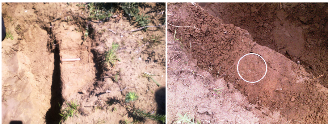
Slika 5.3/15. Uzimanje uzoraka za određivanje zapreminske mase zemljišta u nenarušenom stanju
