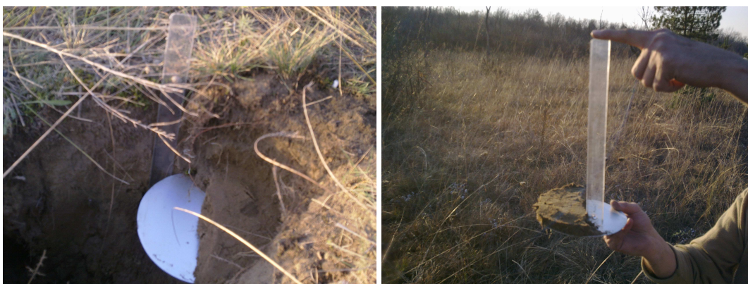
Slika 5.3/12. Uzimanje uzoraka zemljišta metalnim diskom
