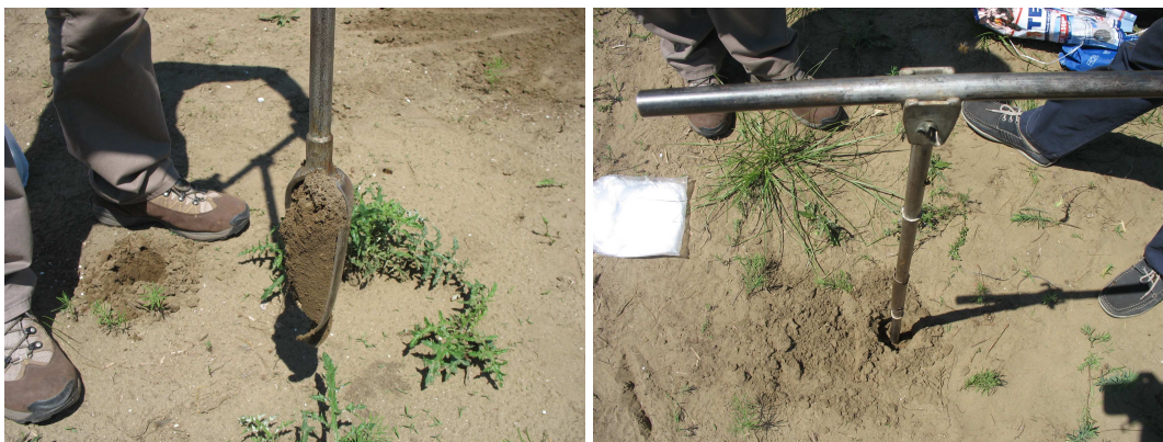
Slika 5.3/11. Uzimanje uzoraka zemljišta sondom
