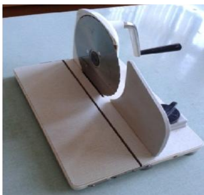
Slika 38: Sekač za rezanje jabuke
