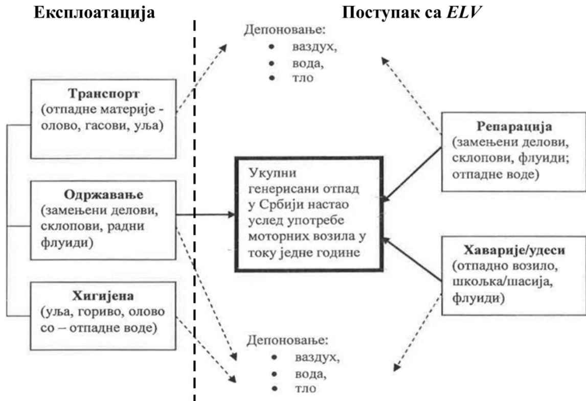
Слика 4.2 Процес генерисања отпада током експлоатације моторних возила
