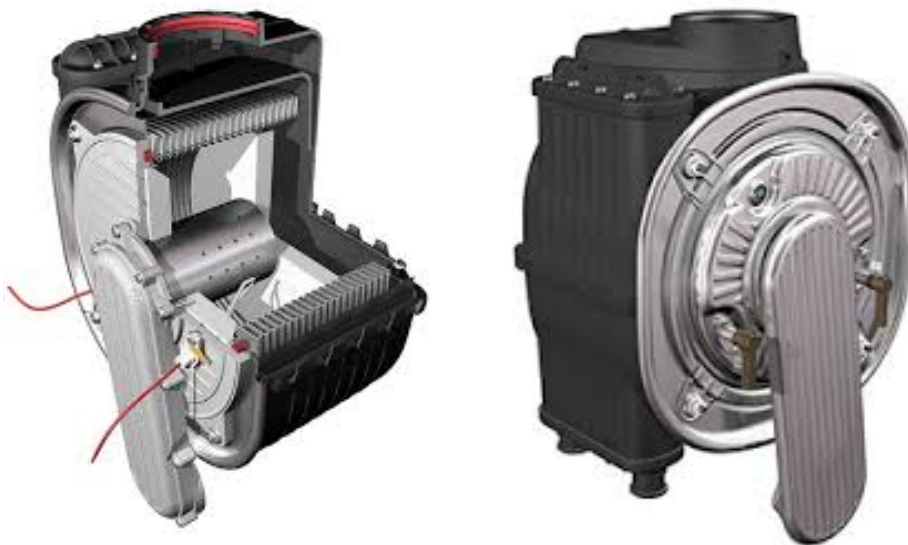
Slika 5.1. Spiralni razmenjivač toplote sa ugrađenim gasnim gorionikom (izrađen od čelične cevi legirane hromom - debljina zida 0,8 mm), (GIANNONI, 2016)
