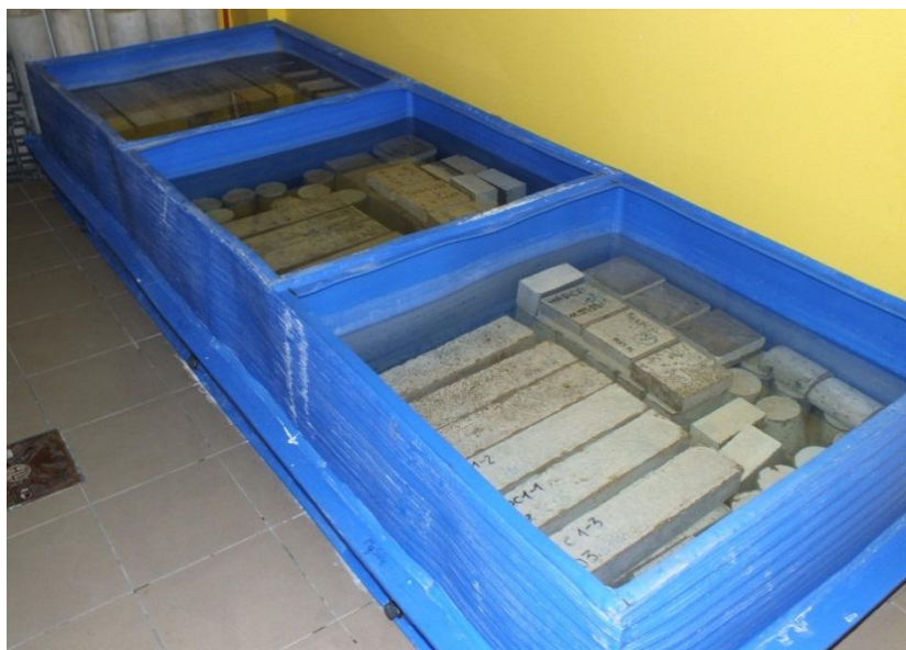
Slika VIII.22–Kondicioniranje uzoraka tokom trajanja eksperimenta
