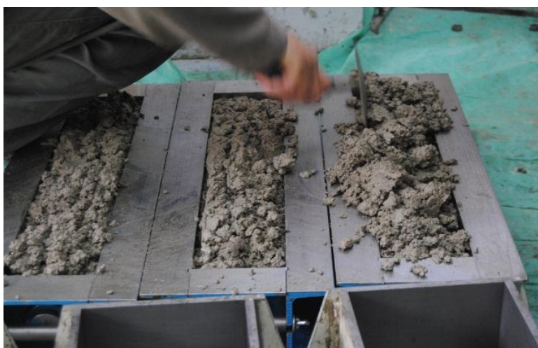
Slika VIII.16– Ugrađivanje betona u kalupe
