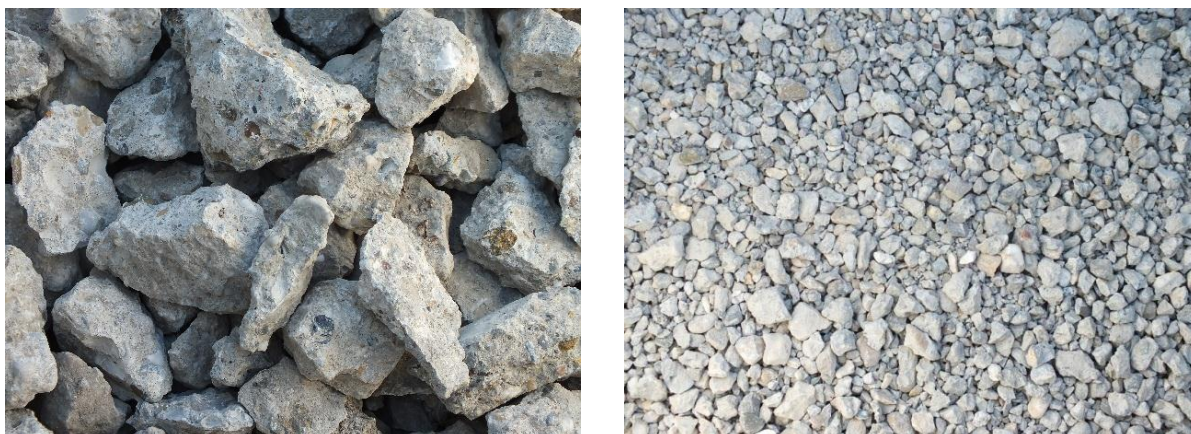
Slika VIII.5- Izgled "starog" betona pre i nakon usitnjavanja
