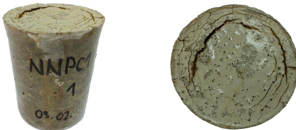
Slika IX.49 - Izgled uzoraka NNPC1 nakon 6 meseci boravka u rastvoru Na_2SO_4
