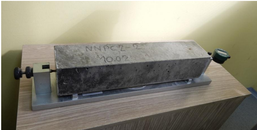
Slika VIII.26- Merenje promene dužine uzorka prema UNI 11307
