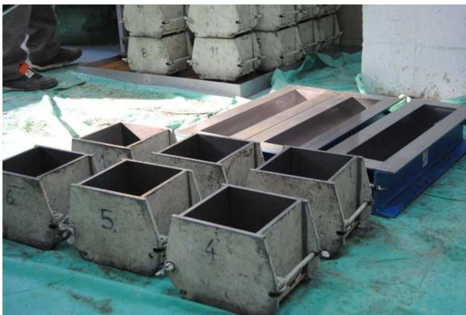
Slika VIII.13 – Pripremljeni kalupi za izradu betonskih kocki, ploča i prizmi
