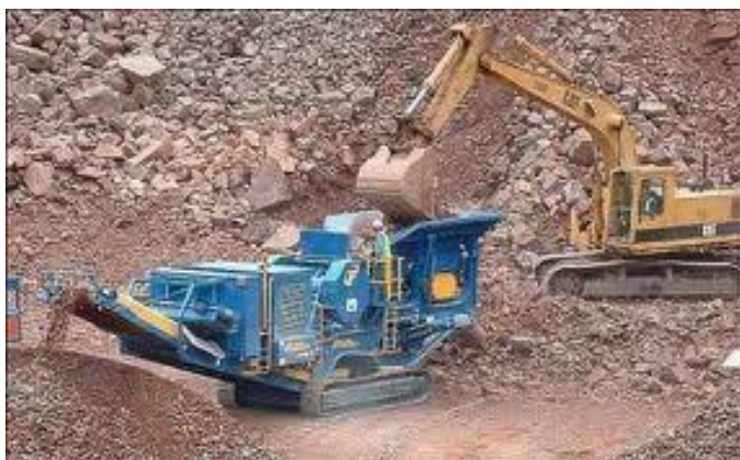
Slika IV.1 –Procesi usitnjavanja otpadnog materijala
