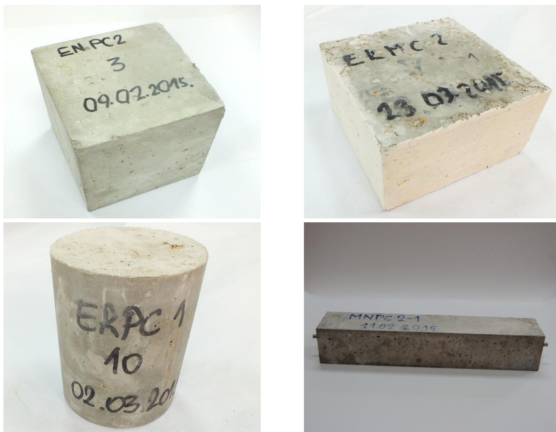
Slika VIII.19 – Uzorci nakon vađenja iz kalupa i obeležavanja
