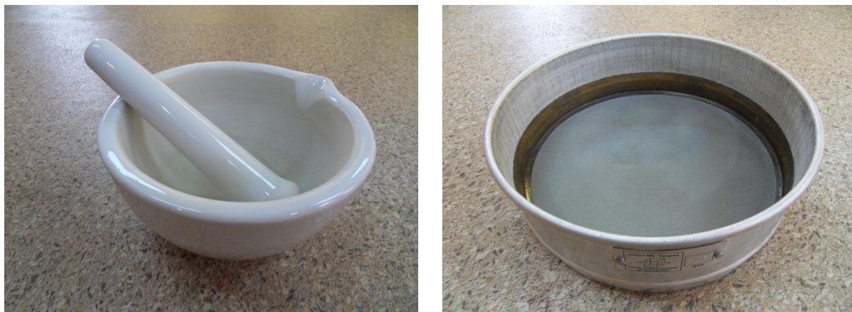
Slika VIII.33 - Avan sa tučkom i sito koji su korišćeni za pripremu uzoraka kod XRD i FTIR
