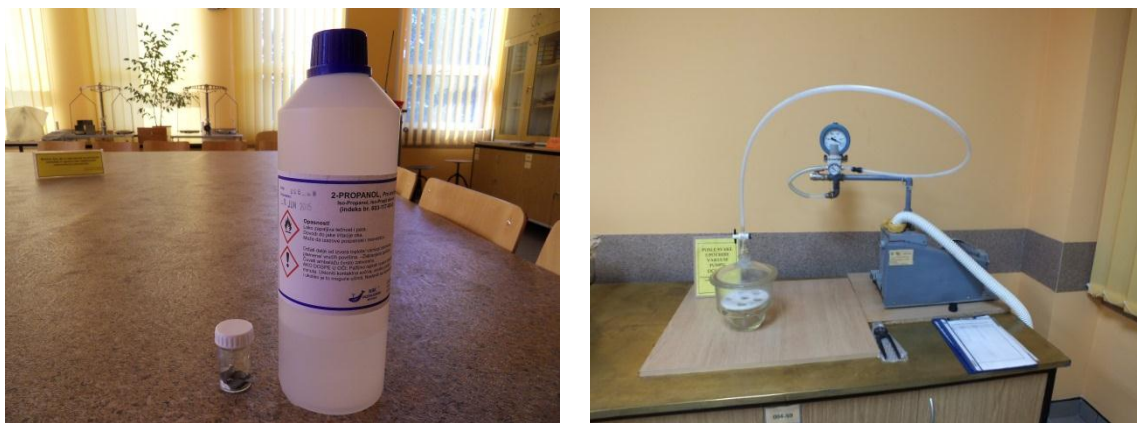
Slika VIII.29- Priprema uzoraka za merenje poroznosti pomoću živine porozimetrije
