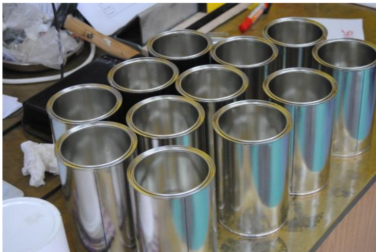
Slika VIII.14 – Pripremljeni kalupi za izradu betonskih cilindara
