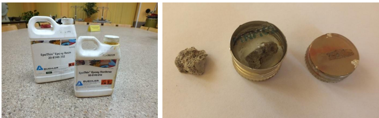
Slika VIII.31- Dvokomponentni niskoviskozni epoksid za zalivanje uzoraka za BSE-EDS
