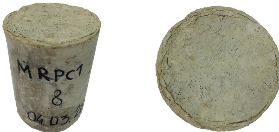
Slika IX.50 - Izled uzoraka MRPC1 nakon 6 meseci boravka u rastvoru MgSO_4
