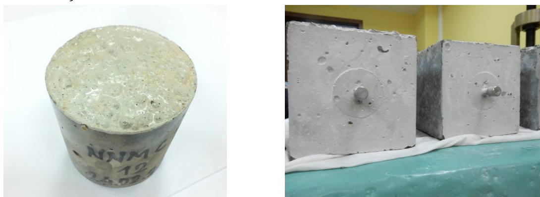
Slika VIII.20–Izgled uzoraka nakon zaštite epoksidnim premazom
