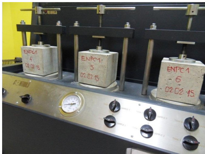
Slika VIII.27- Određivanje upijanje vode pod pritiskom
