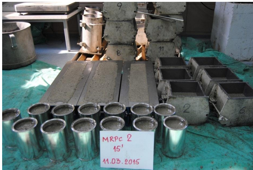
Slika VIII.18 – Beton ugrađen u kalupe
