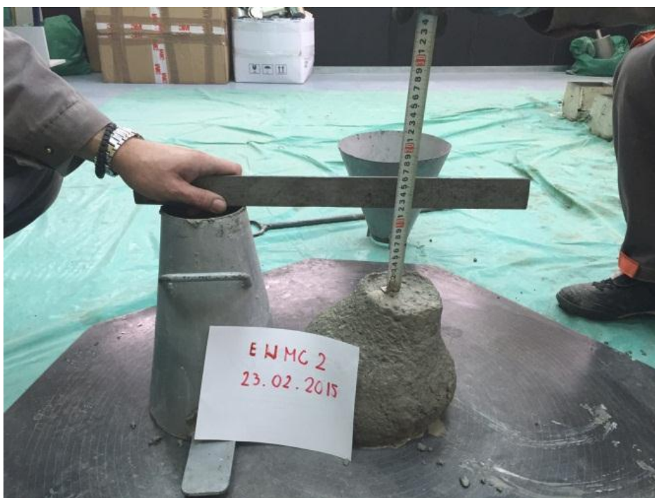
Slika VIII.12– Merenje sleganja betona
