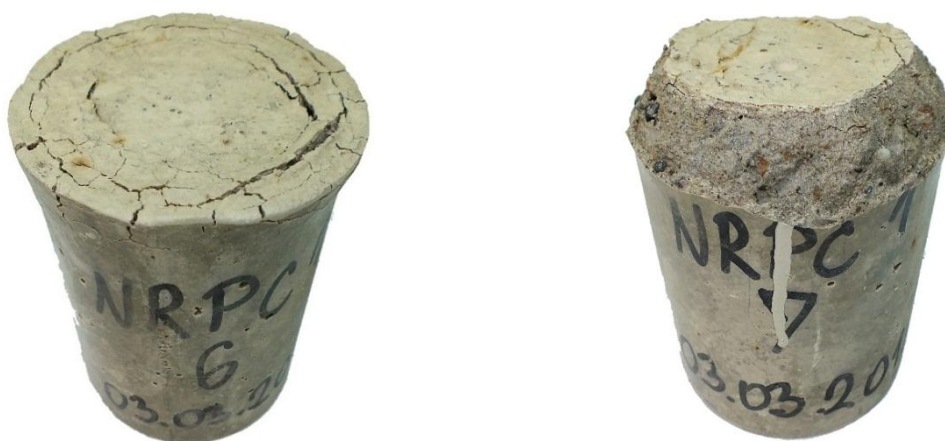
Slika IX.48 - Izgled uzoraka NRPC1 nakon 5 meseci boravka u rastvoru Na_2SO_4
