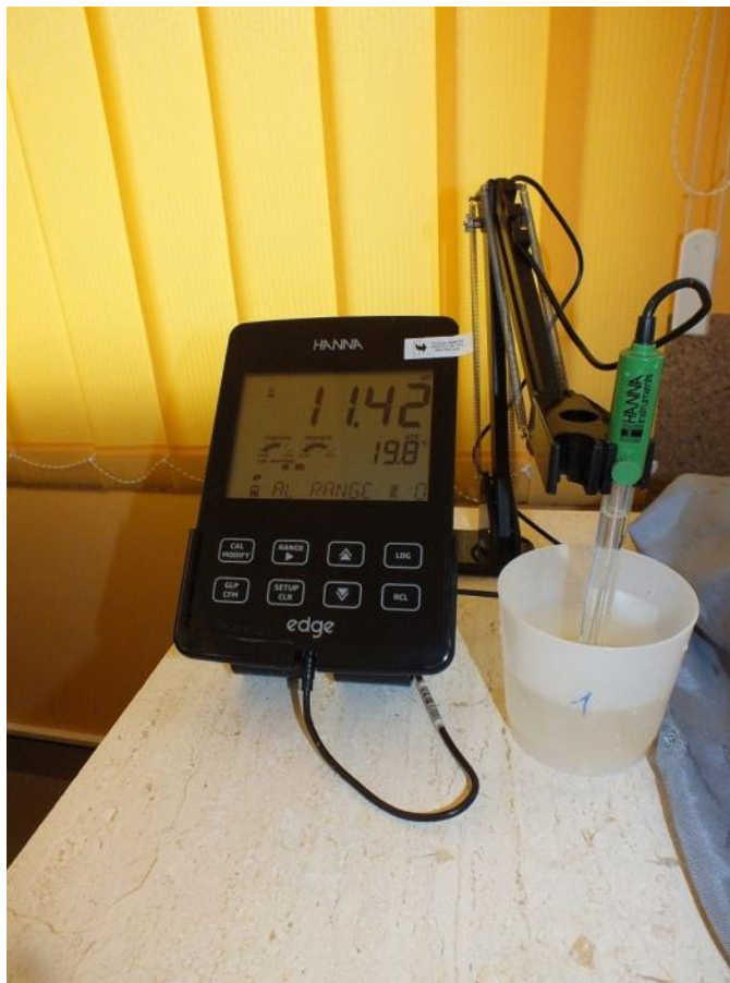
Slika VIII.23–Uređaj za merenje pH vrednosti
