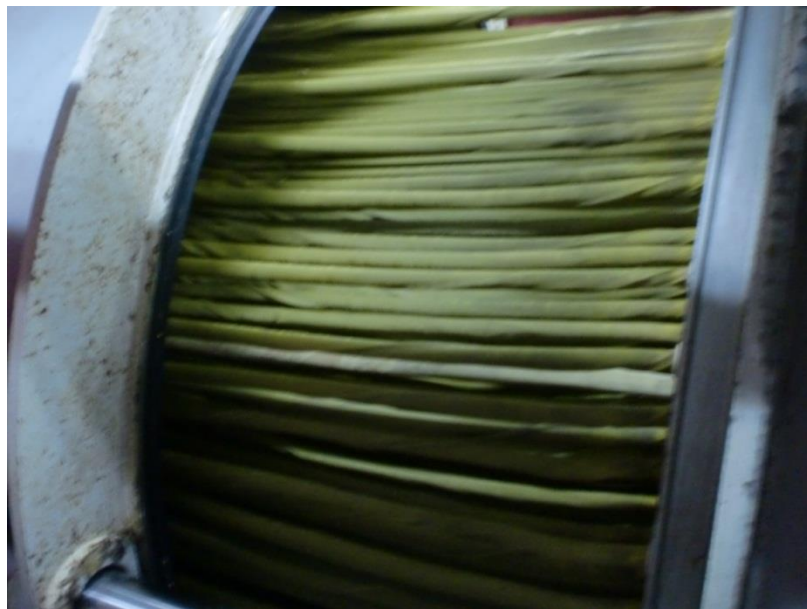
Slika 9. Snop creva Buher prese kroz koja se vrši ceđenje soka jabuke (sopstvena fotografija)
