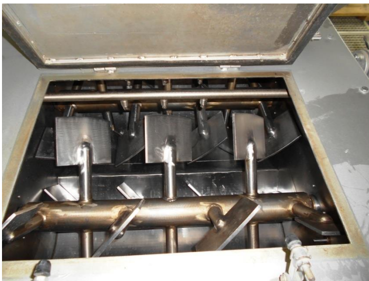
Slika 12. Dvoosovinska lopatasta mešalice (SLHSJ0.2, Muyang, Kina)
