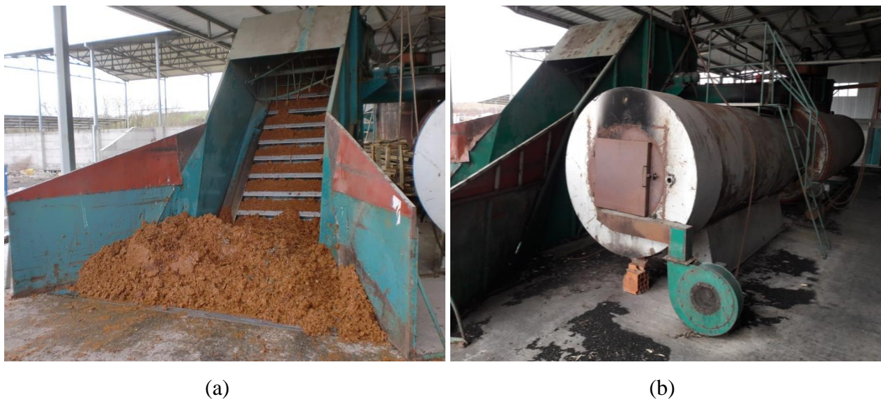
Slika 10. Ulaz jabučnog tropa u sušaru (a) i rotaciona sušara (b) u fabrici VINO Župa a.d. (sopstvena fotografija)
