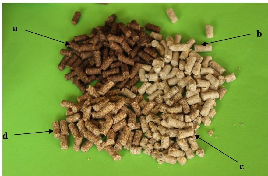
Slika 14. Pelete osušenog jabučnog tropa (a), pelete model smeše koncentrata bez dodatog osušenog jabučnog tropa (0% tropa) (b), pelete model smeše koncentrata sa 10% osušenog jabučnog tropa (c) i model smeše koncentrata sa 20% osušenog jabučnog tropa (d)
