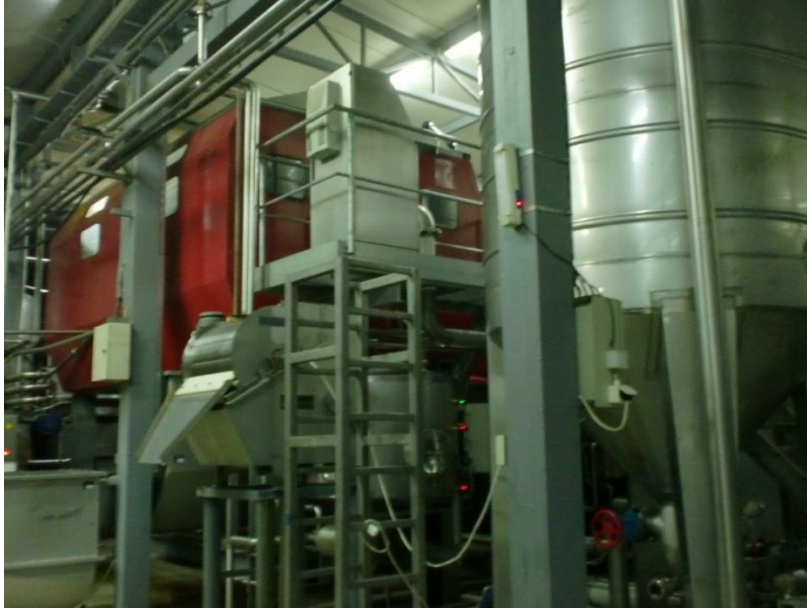
Slika 8. Buher presa kapaciteta 10.000 t/h, Vino Župa a.d., Aleksandrovac (sopstvena fotografija)
