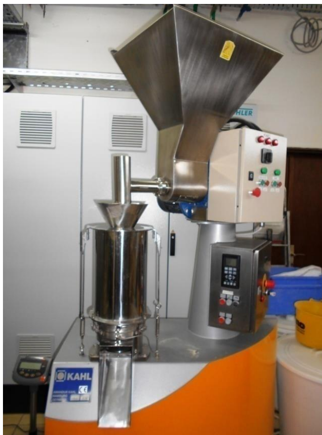
Slika 13. Pelet presa sa ravnom matricom, model 14-145 (Amandus Kahl, Reinbek, Nemačka)
