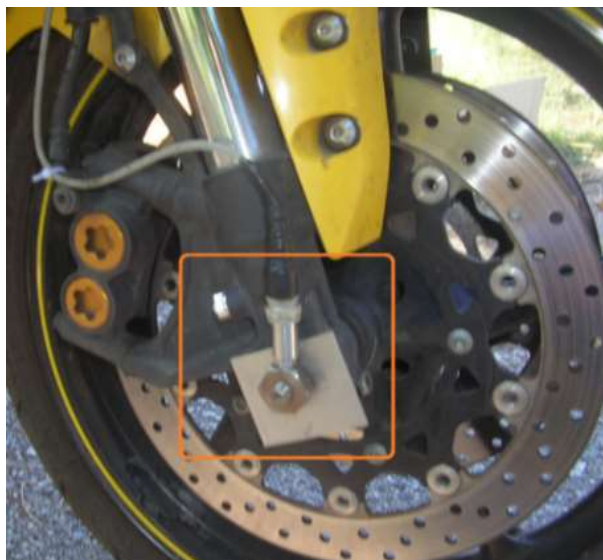
Сл. 6.15 Једноосни давач убрзања HBM B12 на предњем точку
