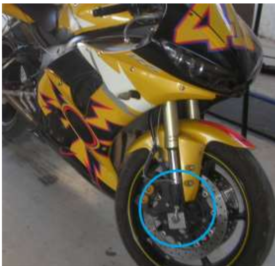
Сл. 6.18 Једноосни давач убрзања HBM В12 на предњем точку
