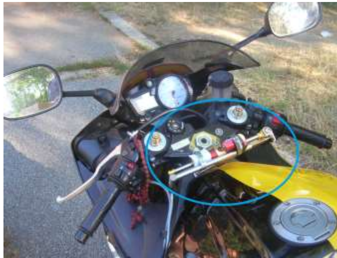
Сл. 6.20 Давач транслаторног померања управљача
