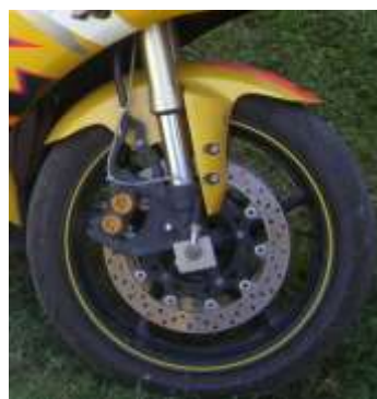
Сл 4.59 Предњи систем еластичног ослањања мотоцикла YAMAHA YZF R6
