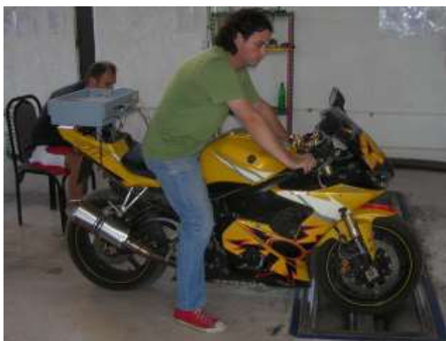
Сл. 6.17 Мотоцикл YAMAHA YZF R6 на линији техничког прегледа – мерни ваљци
