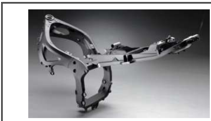
Сл 4.32 Рам „DELTA BOX 3“ мотоцикла YAMAHA R1 (Stoffregen, 2006)
