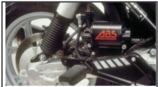
Сл 4.56 Систем против блокирања кочница ABS (BMW, 2016)
