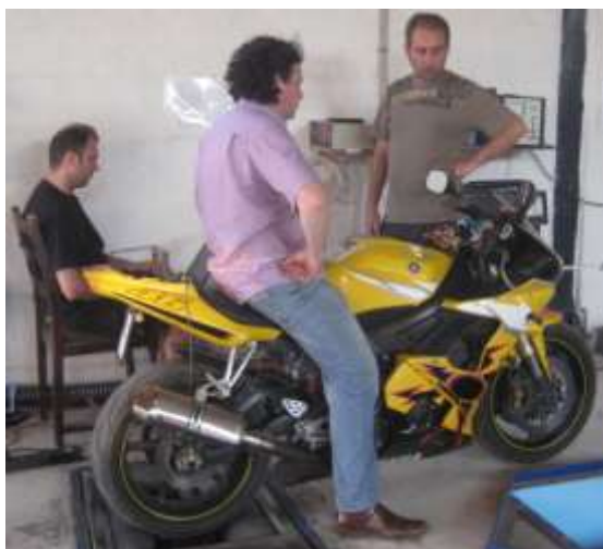
Сл. 6.17 Мотоцикл YAMAHA YZF R6 на линији техничког прегледа – мерни ваљци
