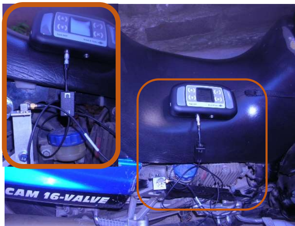
Слика 6.2 Постављање троосног давача на рам мотоцикла
