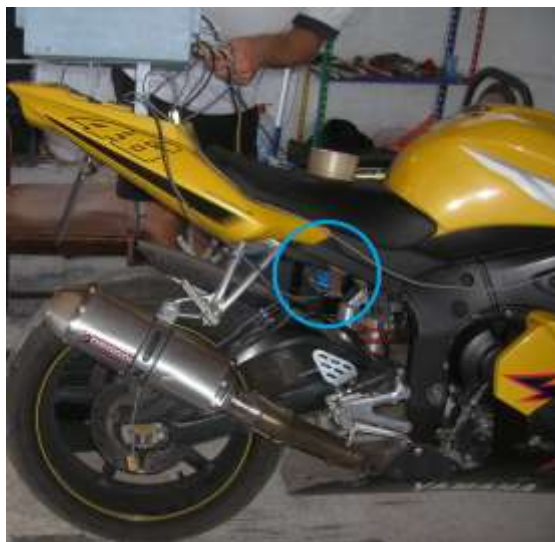
Сл. 6.19 Једноосни давач убрзања HBM В12 на задњем точку
