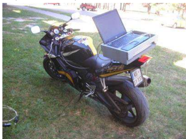
Сл 6.13 Мерни систем HBM Spider8
