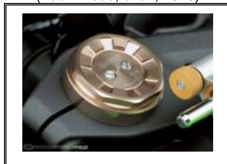
Сл 4.46 „Регулатор“ за подешавање карактеристике виљушке (Paul Thede, et al., 2010)
