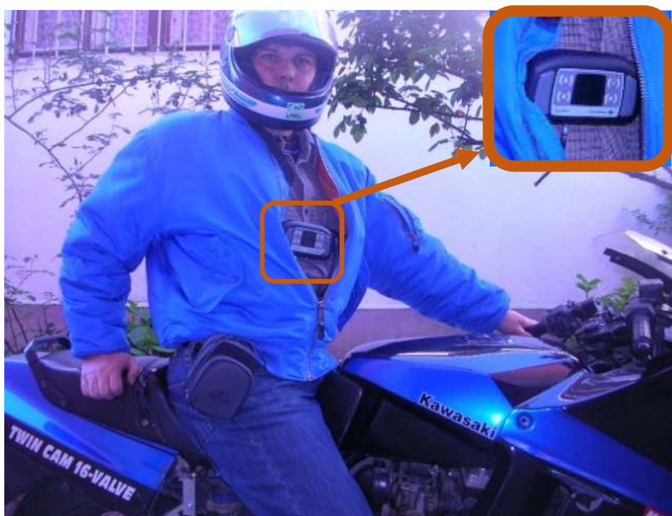
Слика 6.1 Мерач вибрација на телу возача
