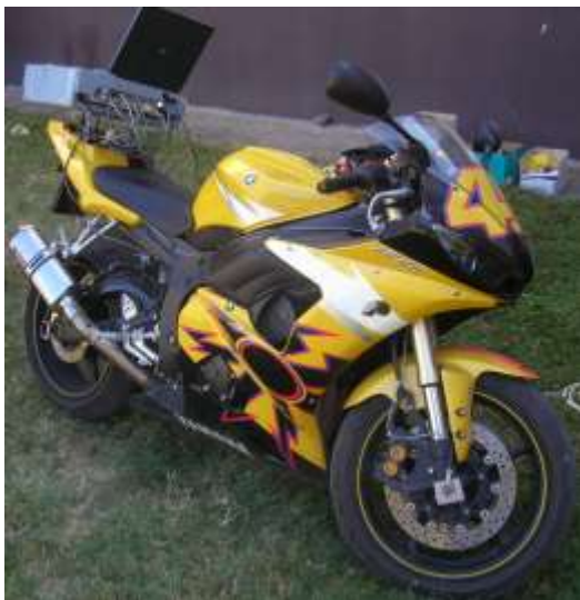
Сл. 6.16 Мотоцикл YAMAHA YZF R6 са мерном опремом HBM SPIDER 8 снимљен из различитих углова
