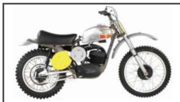
Сл 4.27 Мотоцикл марке HUSQVARNA, са титанијумским рамом (Husqvarna, 2016)
