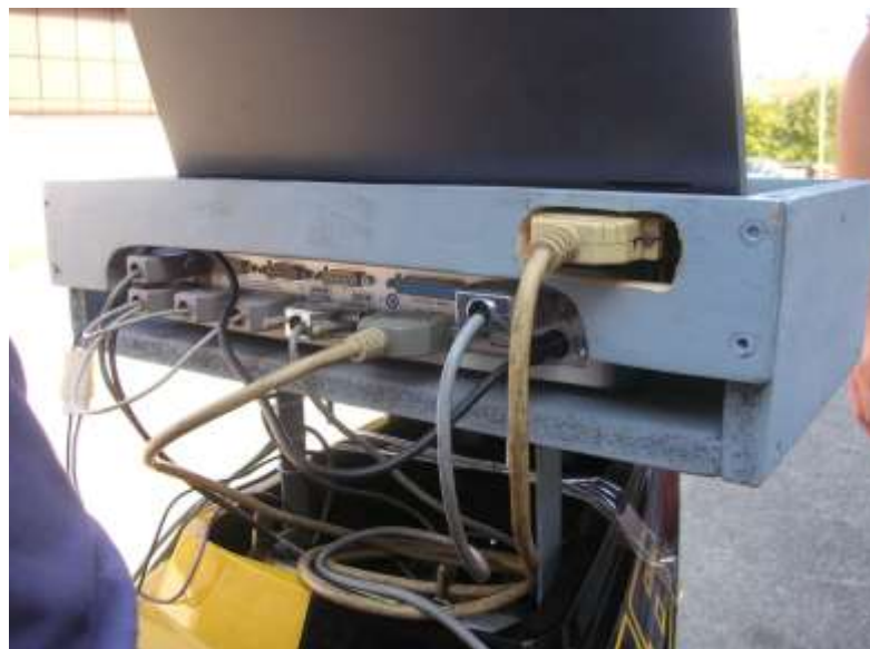
Сл 6.21 Мерни систем HBM Spider 8
