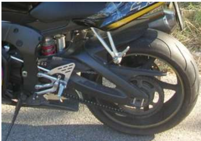
Сл 4.60 Задњи систем еластичног ослањања мотоцикла YAMAHA YZF R6
