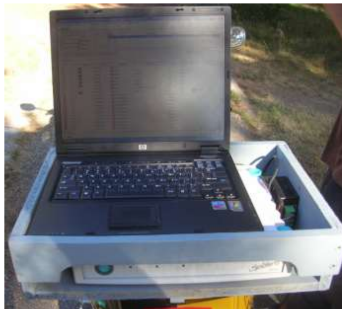
Сл 6.22 Мерни систем HBM Spider 8 са PC рачунаром
