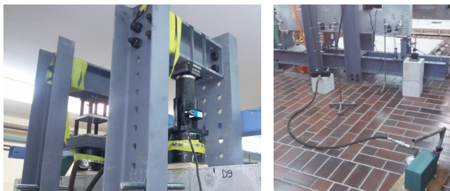
Slika 4.52 - Hidraulična presa sa dinamometrom "SDS CZL110D 20T" i ručna pumpa
