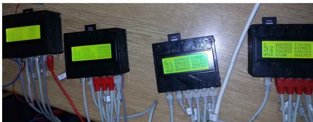
Slika 4.56 - Univerzalni akvizicioni uređaji "Uni Acq System 01-08" za beleženje dilatacija i pomeranja
