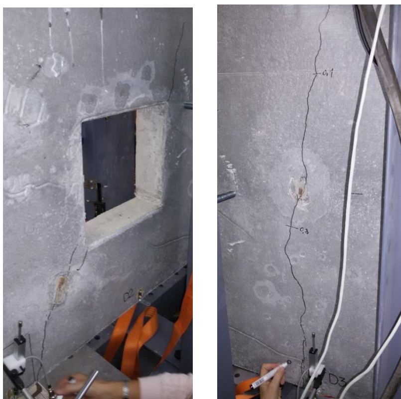
Slika 4.67 - Prve prsline sa zadnje strane površine uzorka Z1
