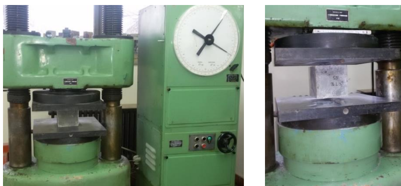
Slika 4.48 - Ispitivanje čvrstoće pri pritisku (levo) i na zatezanje cepanjem (desno)
