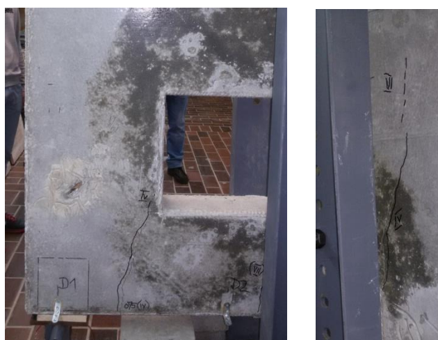
Slika 4.98 - Prsline pri 2x110 kN kod oslonca, ka sredini (levo) i kod otvora (desno) sa zadnje strane površine uzorka Z3
