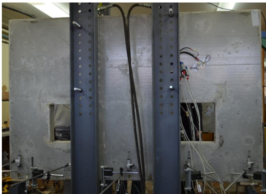
Slika 4.80 - Uzorak Z2 - Aparatura za merenje dilatacija i ugibomeri (zadnja strana)
