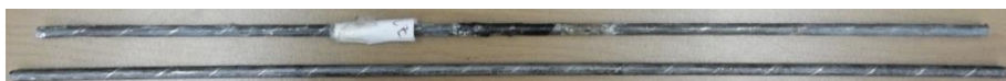
Slika 4.75 - Uzorak armature iz nosača Z1 (gore i sredina) i kontrolni uzorak (dole)
