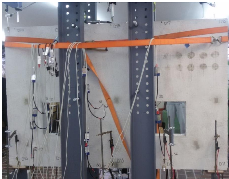
Slika 4.64 - Uzorak Z1 - Aparatura za merenje dilatacija i ugibomeri (prednja strana)
