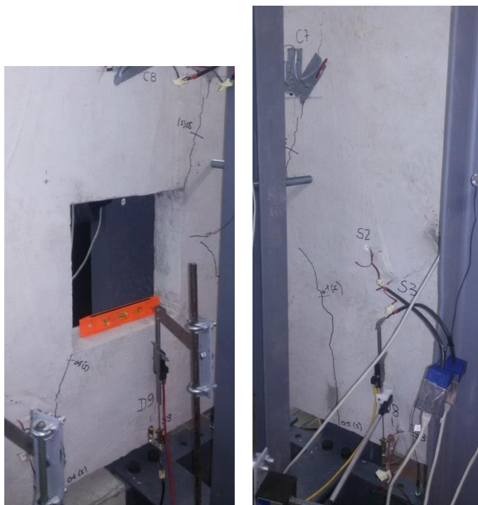
Slika 4.95 - Prve prsline sa prednje strane površine uzorka Z3, kod oslonca (levo) i po sredini (desno)
