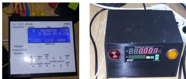
Slika 4.53 - Akvizicioni sistem "Su-tech Caliper Acquisition System" (levo) i analogno-digitalni kontroler "SMY-LH8-IRR4C 5 Digit RS 485" za dinamometar (desno)
