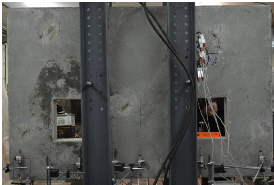
Slika 4.93 - Uzorak Z3 - Aparatura za merenje dilatacija i ugibomeri (zadnja strana)
