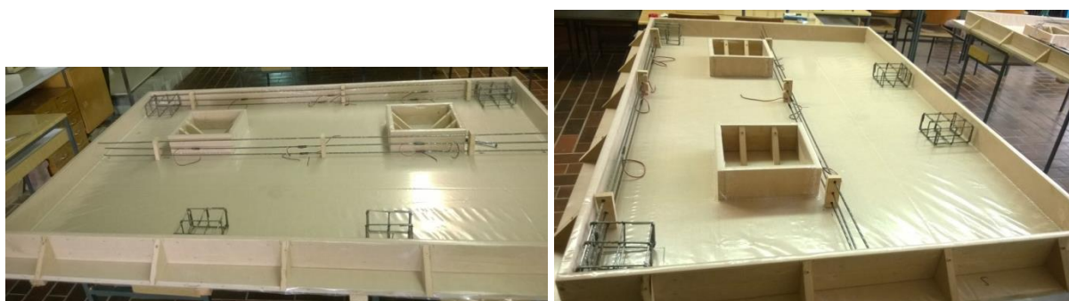
Slika 4.44 - Uzorak Z2 - postavljena armatura i merne trake na armaturi
