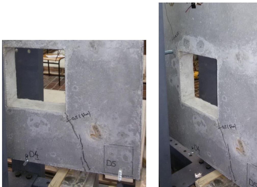
Slika 4.69 - Nove prsline pri 2x105 kN sa zadnje strane površine uzorka Z1
