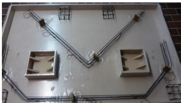
Slika 4.45 - Uzorak Z3 - postavljena armatura i merne trake na armaturi - pogled 1
