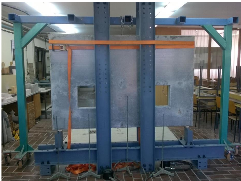
Slika 4.62 - Uzorak Z1 postavljen u konstrukciju metalnog rama
