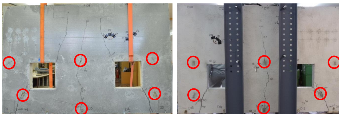
Slika 4.112 - Položaj distancera na uzorku Z1 sa zadnje (levo) i prednje strane zida (desno)
