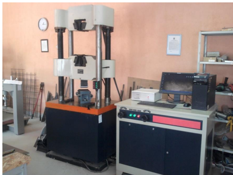
Slika 4.61 - Digitalna kidalica 0-600 kN, Laboratorija za ispitivanje materijala, "Institut za građevinarstvo" d.o.o., Subotica
