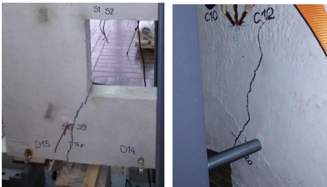
Slika 4.68 - Nove prsline pri 2x105 kN sa prednje strane površine uzorka Z1
