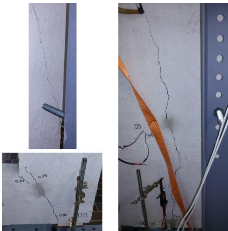
Slika 4.66 - Prve prsline sa prednje strane površine uzorka Z1
