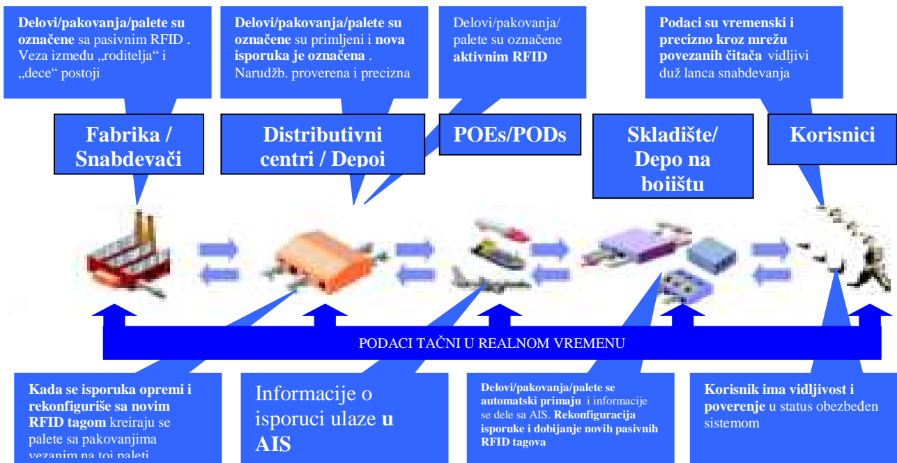
Slika 53. Prikazuje lanac snabdevanja koji koristi RFID tehnologiju
