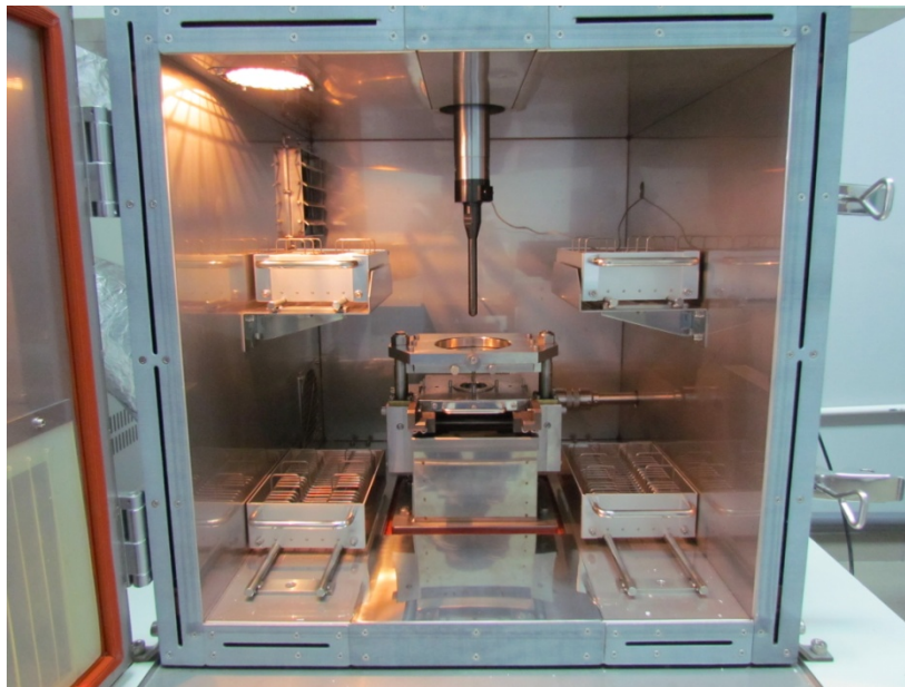
Slika 3.18 Komora uređaja za udar kontrolisanom energijom
