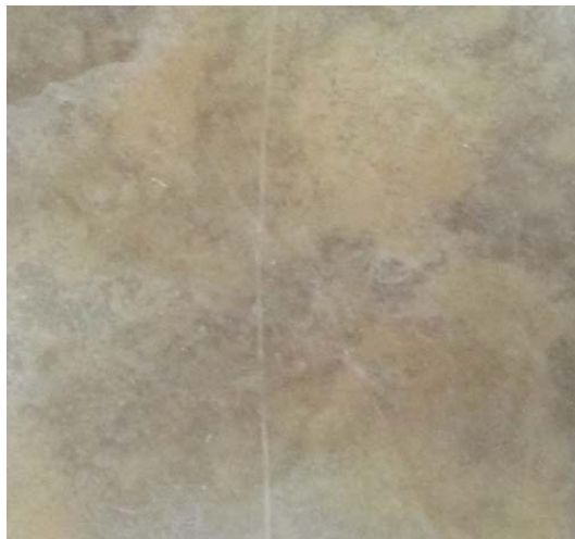
Slika 4.63 Fotografija zone oštećenja 24 sata nakon udara
