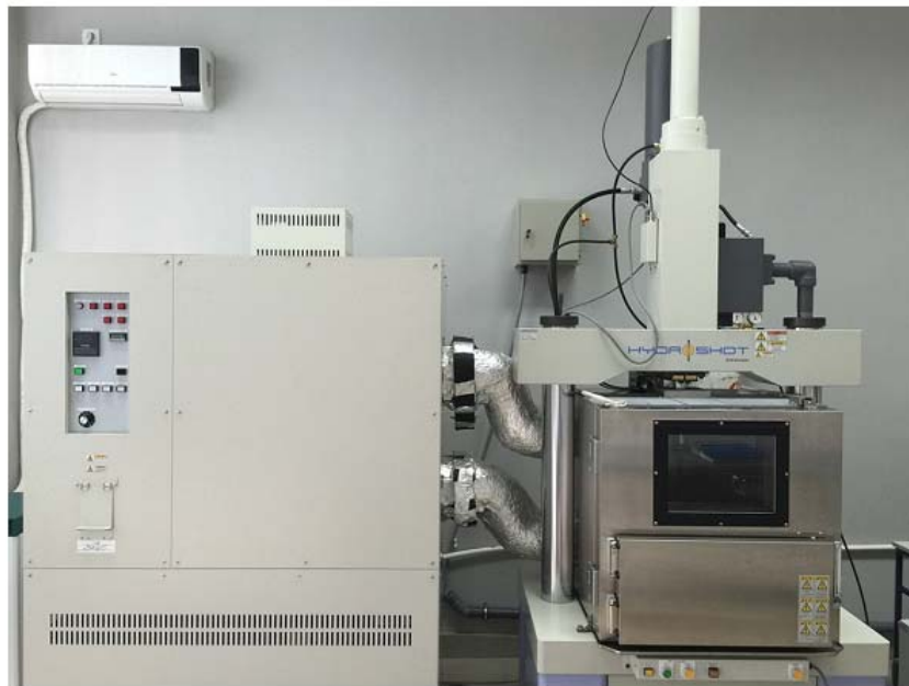
Slika 3.20 Uređaj za ispitivanje udarom kontrolisane energije sa termostatičkom komorom (levo)
