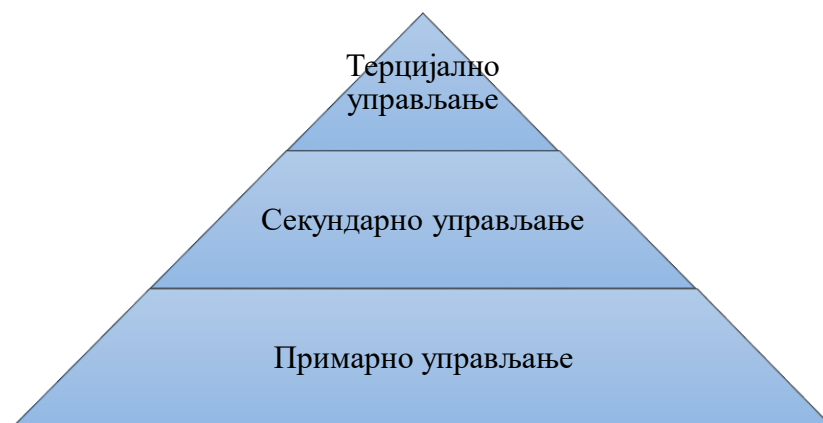
Слика 6. Хијерархијски нивои управљања микро мрежом
