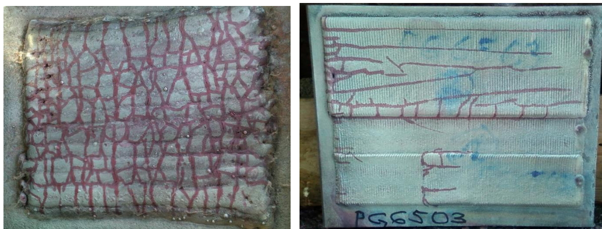
а) б) Слика 4.20. Узорци испитани течним пенетрантима а) додатни материјал Г, б) додатни материјал А
