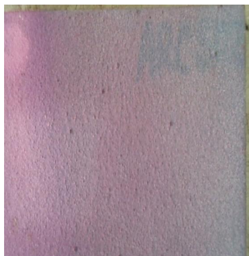
Слика 4.21. Узорци испитани течним пенетрантима: а) додатни материјал В, б) додатни материјал Б
