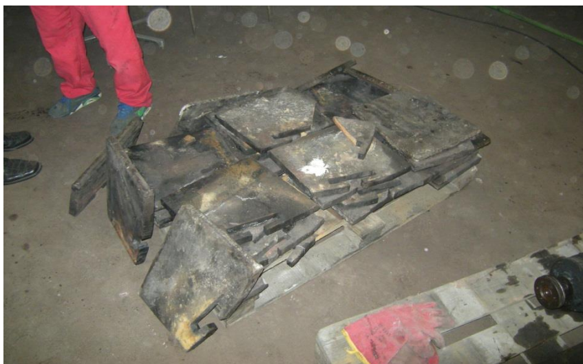
Слика 5.12. Изглед усисних плоча са нанесеним антихабајућим слојем након експлоатације
