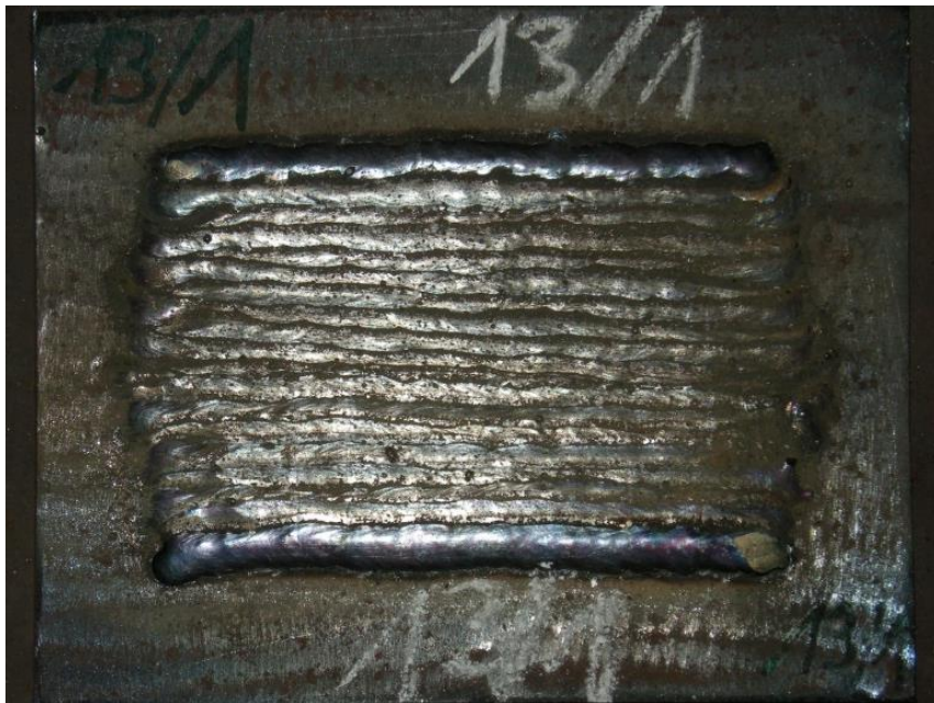
Слика 4.13. Узорак са нанесеним антихабајућим материјалом Д
