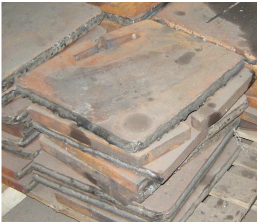
Слика 5.5. Изглед наварених усисних плоча са додатним материјалом Г
