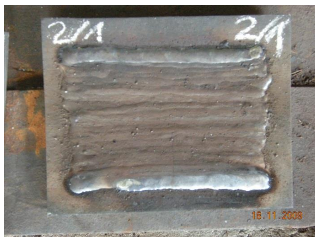
Слика 4.12. Узорак са нанесеним антихабајућим материјалом Г
