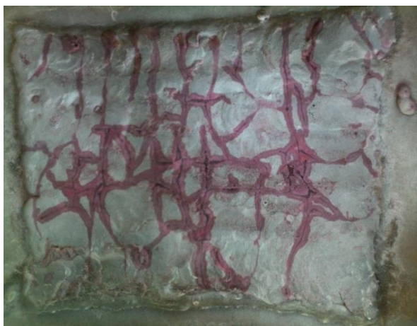
Слика 4.22. Узорци испитани течним пенетрантима а) додатни материјал Ђ и б) додатни материјал Д
