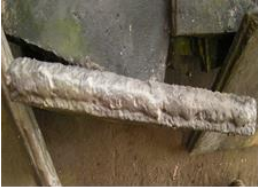
Слика 5.6. Изглед усисне плоче након наваривања са додатним материјалом Ђ
