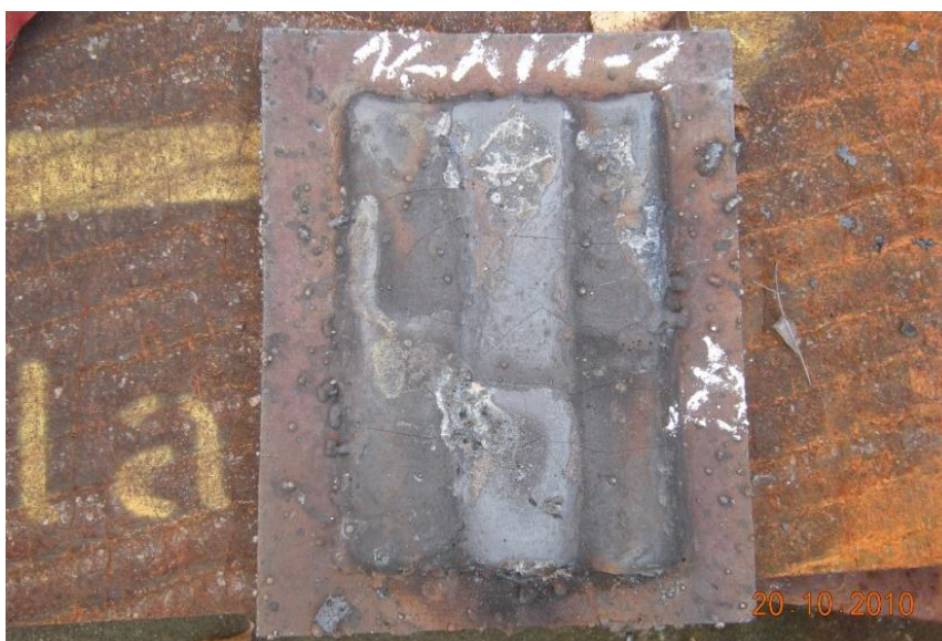
Слика 4.14. Узорак са додатним материјалом Ђ (самозаштитна жица)
