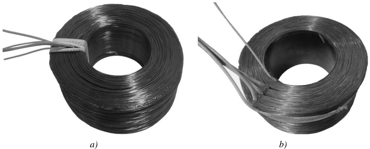
Slika 6.3. Namotaji prototipa magnetoreološke kočnice, a) prvi namotaj, b) drugi – zamenski namotaj
