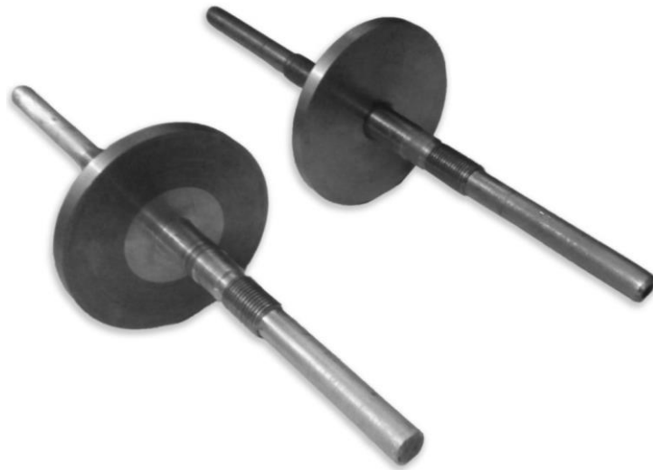
Slika 6.2. Elementi rotorskog sklopa prototipa 1 i prototipa 2
