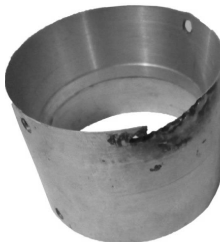
Slika 6.4. Izgled oštećene aluminijumske čaure
