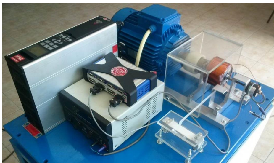
Slika 4.19. Laboratorijski uređaj za ispitivanje kočnih svojstava drugog preliminarnog prototipa magnetoreološke kočnice
