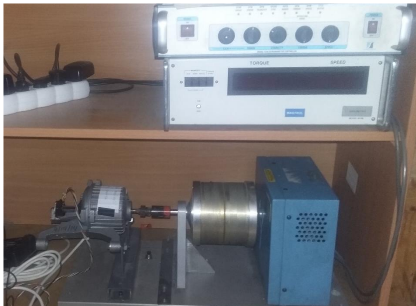
Slika 5.2 Eksperimentalna postavka za testiranje algoritma za digitalno upravljanje pogonom sa PMSM
